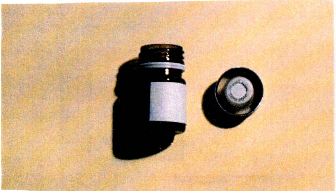
Figura 17: Detalle del tapón del frasco que contiene material desecante para proteger de la humedad.
