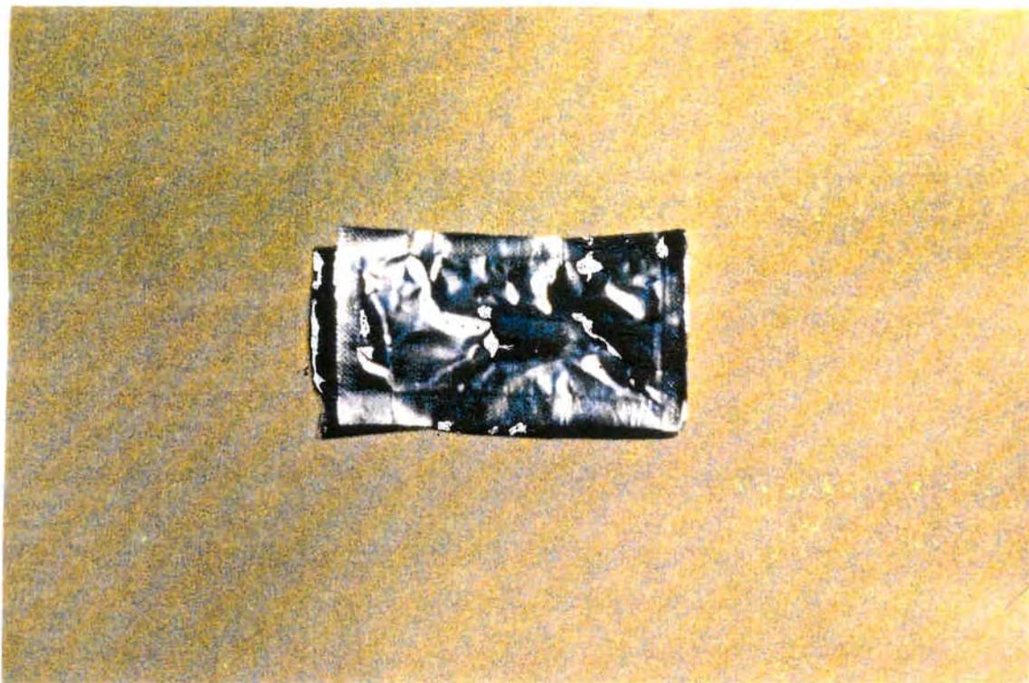
Figura 23: Detalle de una muestra reenvasada utilizando como material de reenvasado complejo de aluminio-papel y PVC.
