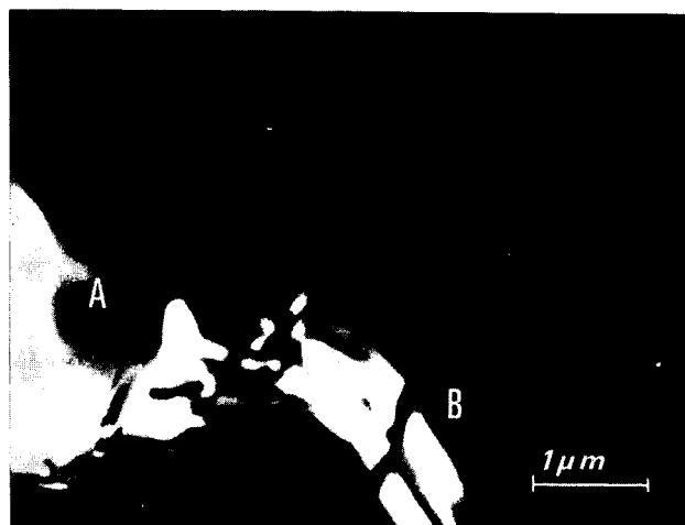
Fig. 3. Imatge obtinguda amb la reflexió (111), (camp fosc). Les làmines A i B són paral·leles a (100).
