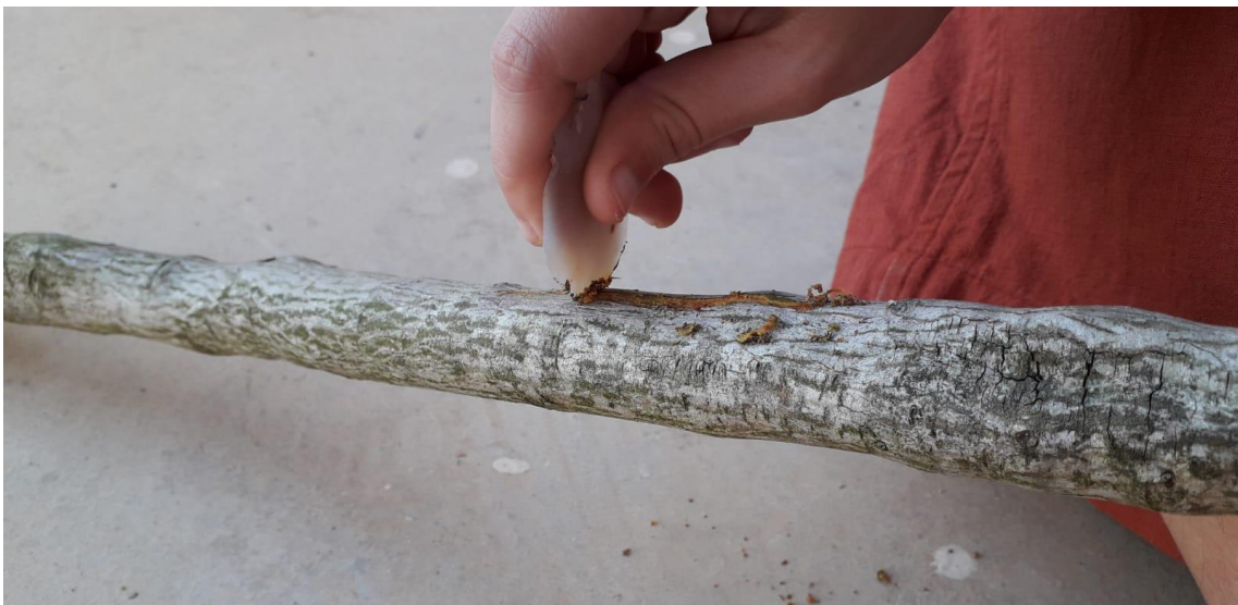
Figura suplementària 6: Fotografia de la part experimental del treball. Amb la peça Exp-2 es va gratar amb un angle de 90^{\circ} durant 15 minuts una branca fresca.
