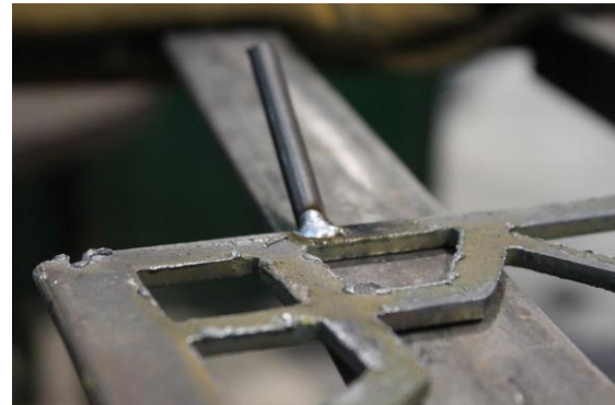
14. Detalle, varilla soldada.
