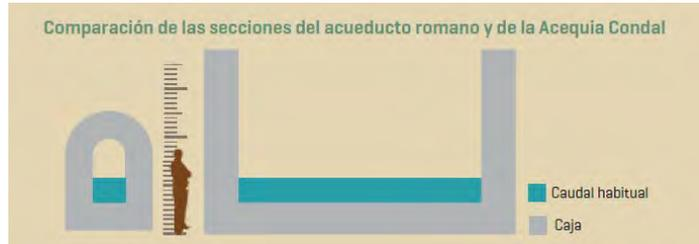
Ilustración 178. Comparación de las secciones del acueducto romano y de la Acequia Condal. Fuente: MUHBA.
