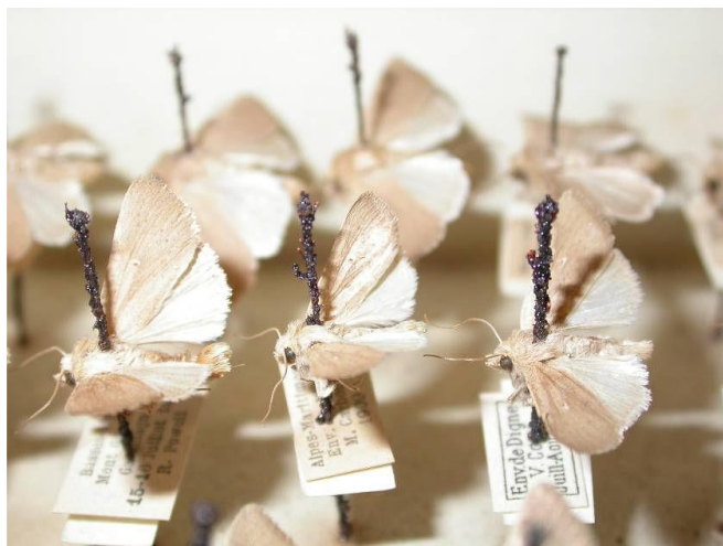
Fig. 9: Alfileres de acero no inoxidable con formación de óxido.
