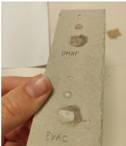
Fig. 23: El DMHF se ha podido retirar por completo. Fotografía: Alexandra Viladot
