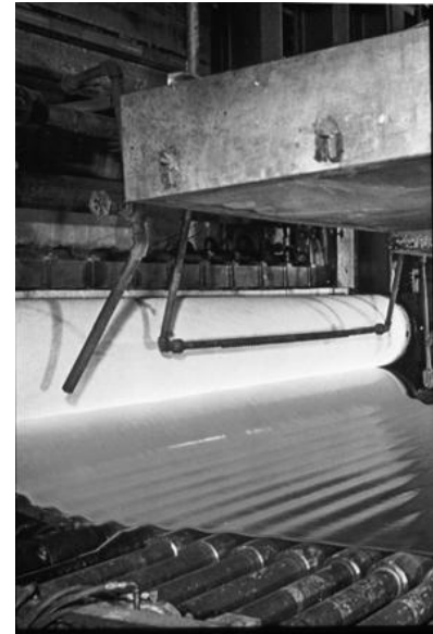
Fig. 10: Imatge del procés de producció mitjançant el procediment de laminat continu. Font: http://glassproperties.com/references/Flat&FabGlasEngHandout.pdf
