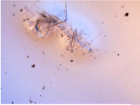
Fig. 21c Possible desvitrificació de la fase cristal·lina \beta -wollastonita o devitrita Font pròpia (180X)
