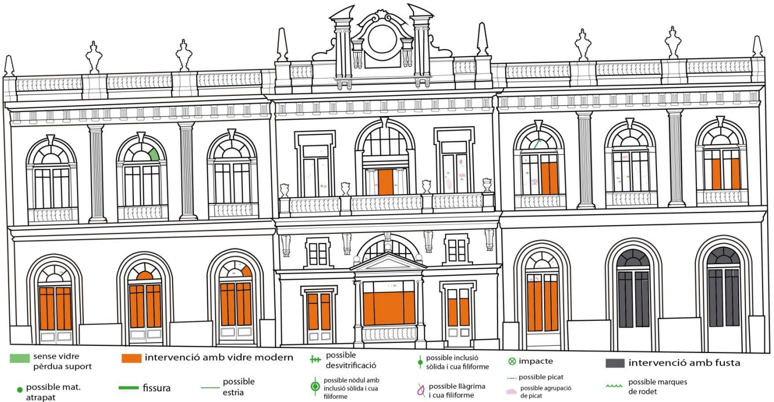
Mapa 3 – Gràfica visual dels defectes del vidre antic i degradacions en la façana principal
