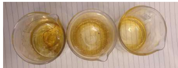
Figura 55. Fotografia final de les mostres de cola de peix emmagatzemades a 35 °C destapades (Marina Candela)
