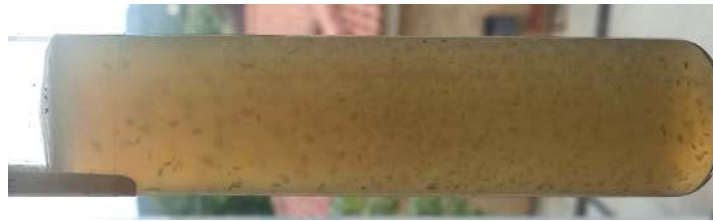
Figura 45. Cristalls a l'interior de la mostra d'agar-agar sense conservant (Marina Candela)
