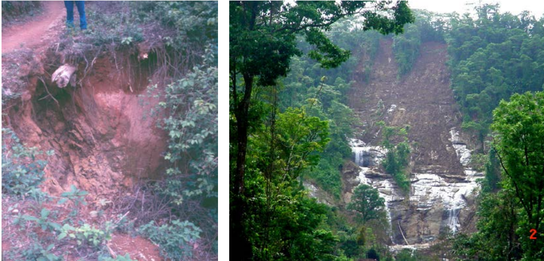
Fig. 1.13. Ejemplos de surgencias de agua observadas en zonas afectadas por movimientos de ladera. En la izquierda, zona de rotura observada en el municipio de San Pedro del Norte (Departamento de Chinandega). En la derecha, surgencia de agua entre la formación superficial y la roca del sustrato, observada en un movimiento reciente, correspondiente al evento de junio del 2004 en Río Blanco (fotografía cedida por Victor Casado – Farmacéuticos Mundi).
