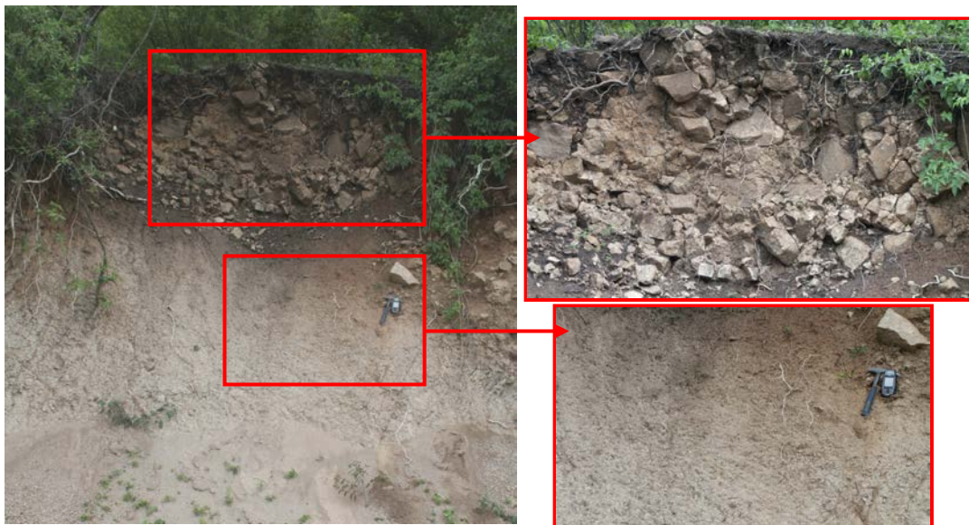
Fig. 1.11. A la izquierda, conjunto de la formación superficial observada en la cicatriz de un movimiento de ladera en la zona de San Nicolás, con dos capas de material diferenciado. La foto derecha superior muestra un detalle de la formación detrítica formada por bloques angulosos a subredondeados de granulometrías diferentes, envueltos de una matriz fina. En la foto derecha inferior detalle del material de alteración de la roca del sustrato formado por materiales finos de granulometría más homogénea.
