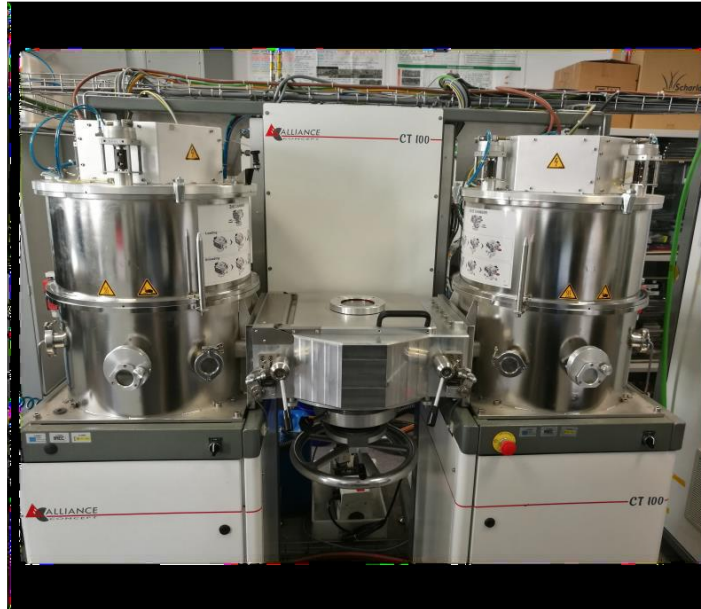
Figura 2. Equipo de pulverización catódica magnetrón Alliance Concept CT100 de las instalaciones de IREC, utilizado durante el proyecto de tesis
