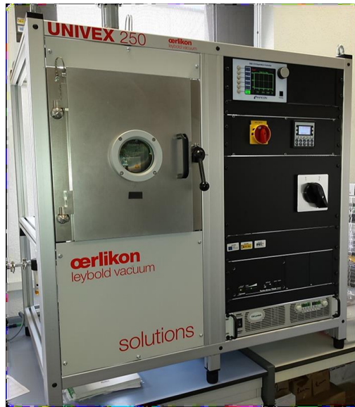
Figura 8. Evaporador térmico Oerlikon Univex 250 de las instalaciones del IREC utilizado durante el proyecto de tesis.
