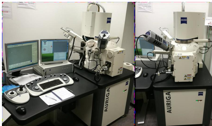
Figura 13. Equipo ZEISS Series Auriga FE-SEM utilizado
