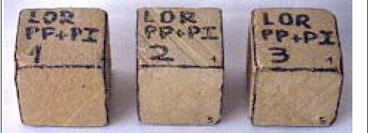
Foto 48. Probetas tratadas con PPPI por 6 caras, envejecidas de la Calcilutita del Lorito.
