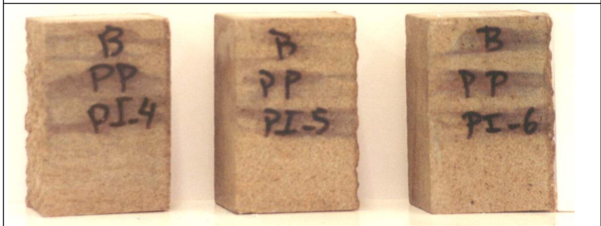
Foto 61. Probetas tratadas con PPPI, antes de ser envejecidas de la Arenisca de Durango.
