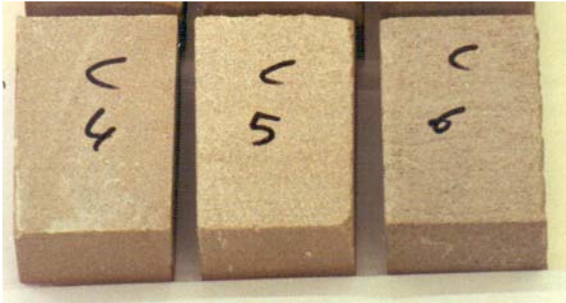
Foto 23. Probetas antes de ser envejecidas de la Arenisca de Begoña.
