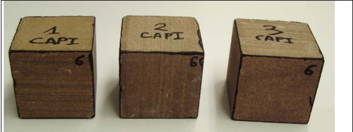
Foto 35. Probetas tratadas con CAPI por 4 caras, antes de ser envejecidas de la Arenisca del Figaró.
