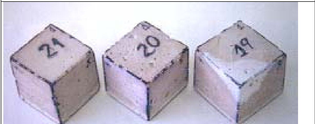
Foto 86. Probetas sin tratar, envejecidas de Parrot's Mix 4.
