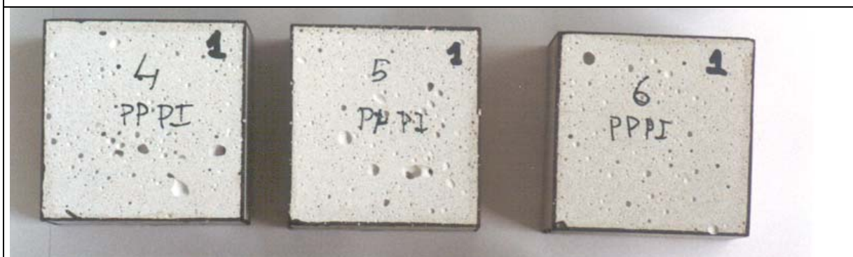
Foto 89. Probetas tratadas con PPPI, antes de ser envejecidas de Parrot's Mix 4.
