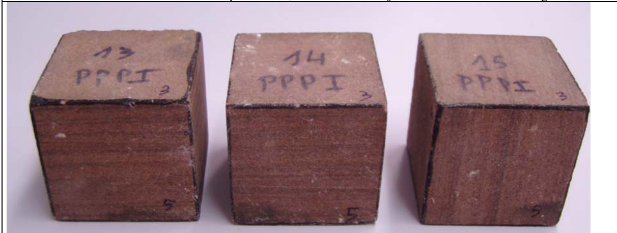
Foto 38. Probetas tratadas con PPPI por 6 caras, envejecidas de la Arenisca del Figaró.
