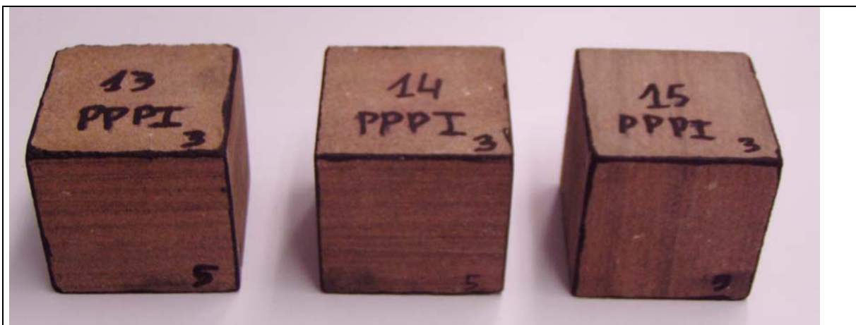
Foto 37. Probetas tratadas con PPPI por 6 caras, antes de ser envejecidas de la Arenisca del Figaró.
