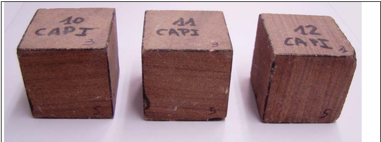
Foto 34. Probetas tratadas con CAPI por 6 caras, envejecidas de la Arenisca del Figaró.
