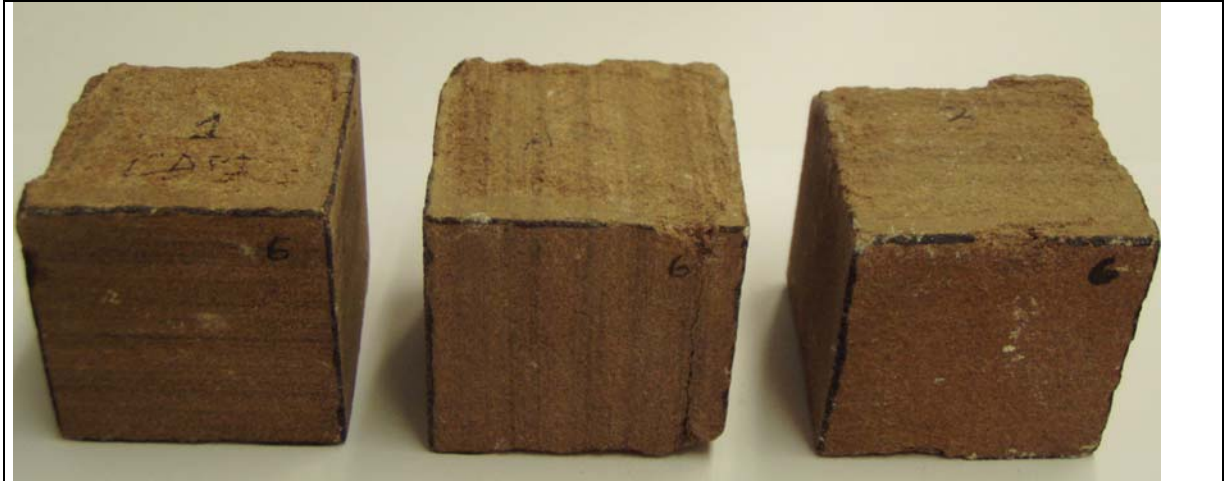
Foto 36. Probetas tratadas con CAPI por 4 caras, envejecidas de la Arenisca del Figaró.
