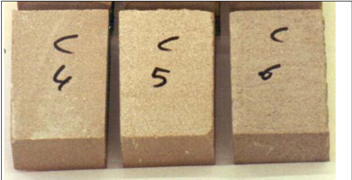
Foto 63. Probetas sin tratar, antes de ser envejecidas de la Arenisca de Begoña.
