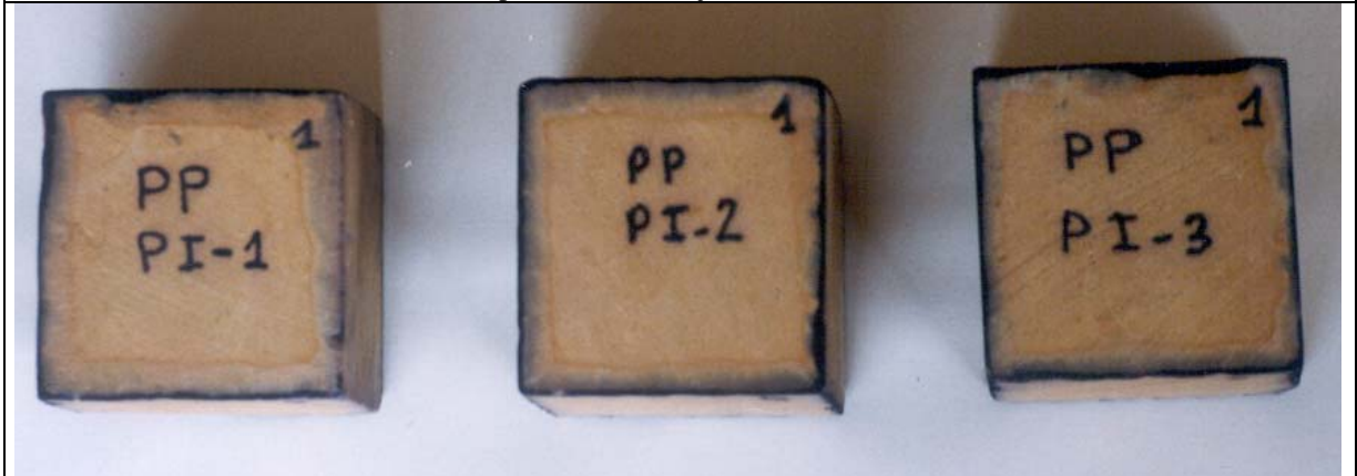
Foto 49. Probetas tratadas con PPPI por 4 caras, antes de ser envejecidas de la Calcilutita del Lorito.
