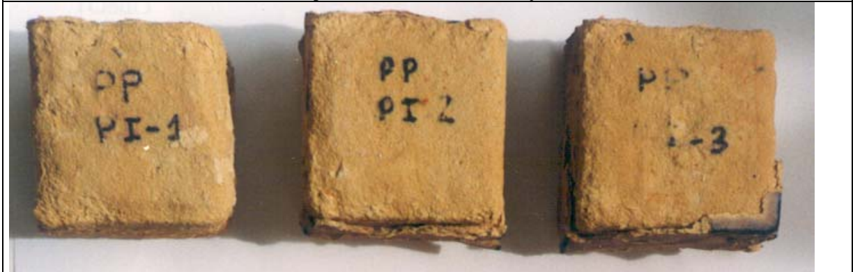
Foto 50. Probetas tratadas con PPPI por 4 caras, envejecidas de la Calcilutita del Lorito.
