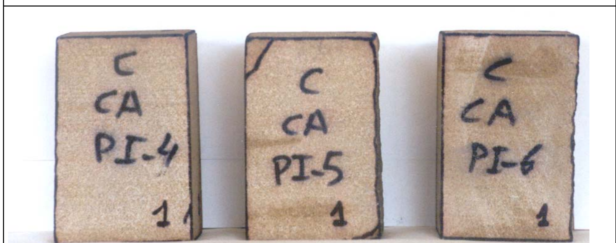
Foto 66. Probetas tratadas con CAPI, envejecidas de la Arenisca de Begoña.
