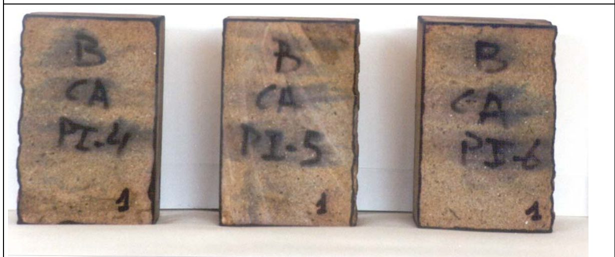
Foto 60. Probetas tratadas con CAPI, envejecidas de la Arenisca de Durango.
