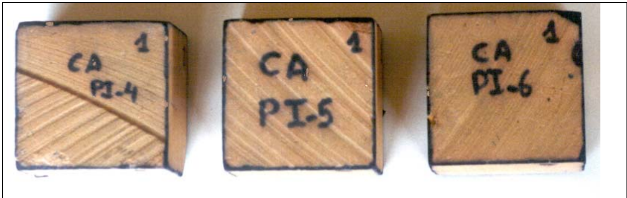
Foto 44. Probetas tratadas con CAPI por 6 caras, envejecidas de la Calcilutita del Lorito.
