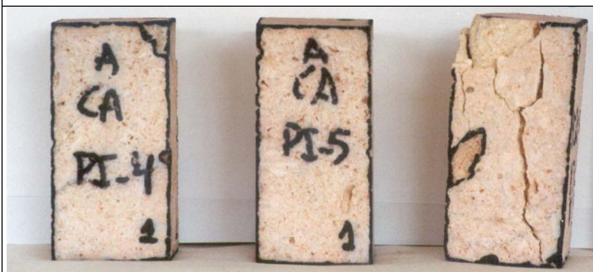
Foto 54. Probetas tratadas con CAPI, envejecidas de la Caliza de Hontoria.
