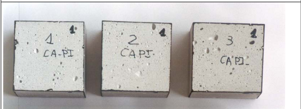
Foto 87. Probetas tratadas con CAPI, antes de ser envejecidas de Parrot's Mix 4.
