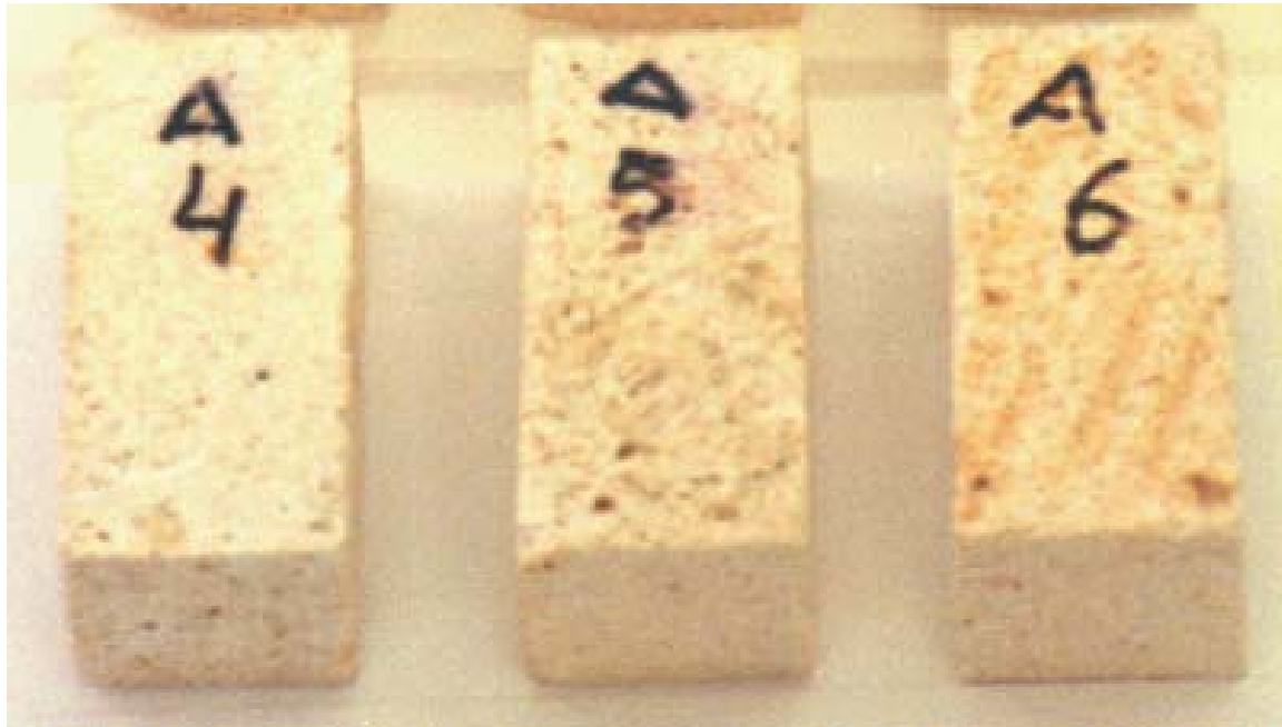
Foto 19. Probetas antes de ser envejecidas de la Caliza de Hontoria.
