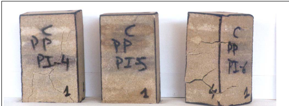
Foto 68. Probetas tratadas con PPPI, envejecidas de la Arenisca de Begoña.
