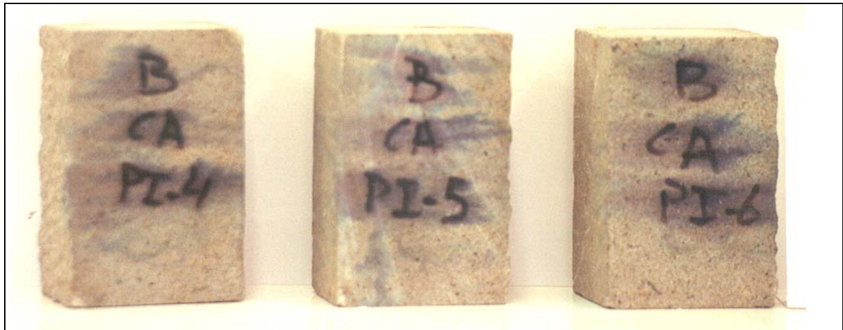
Foto 59. Probetas tratadas con CAPI, antes de ser envejecidas de la Arenisca de Durango.
