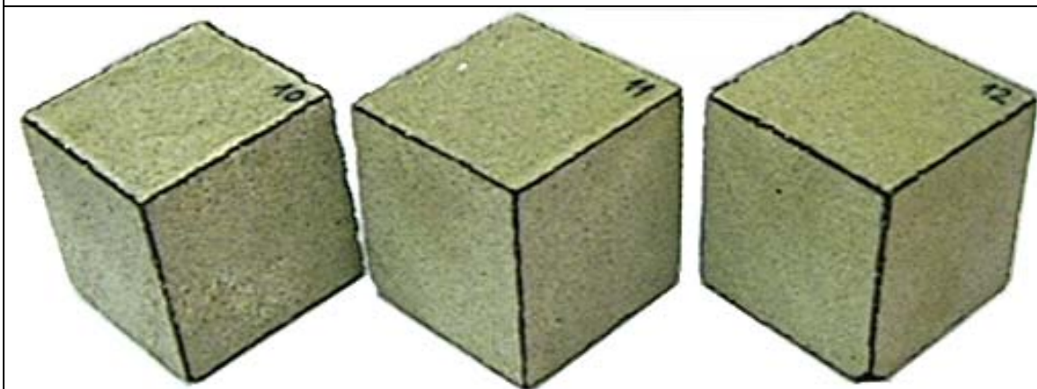
Foto 79. Probetas tratadas con CAPI, antes de ser envejecidas tras el ensayo de hielo – deshielo, de la Arenisca de Montjuïc.
