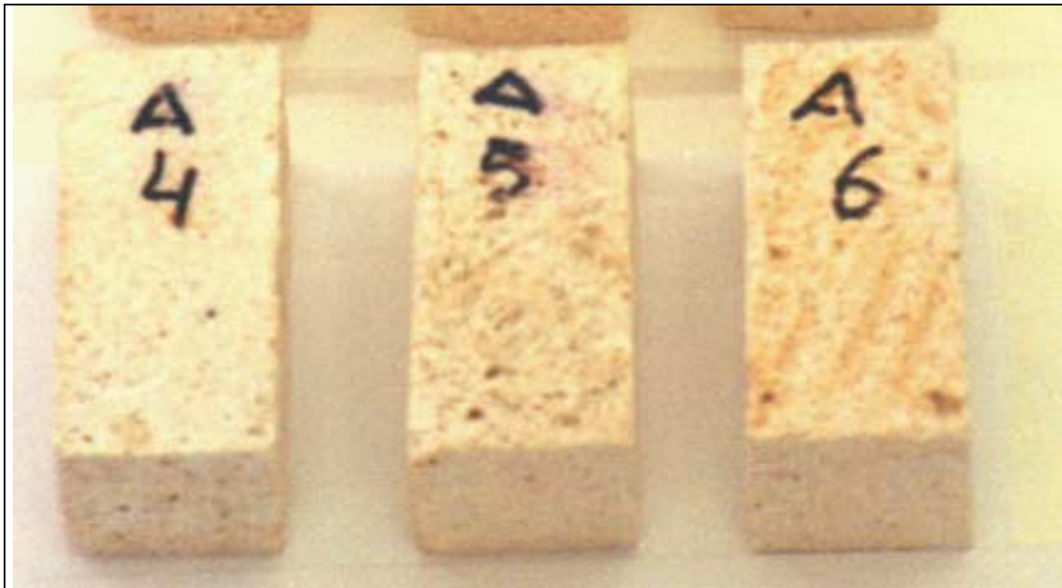
Foto 51. Probetas sin tratar, antes de ser envejecidas de la Caliza de Hontoria.
