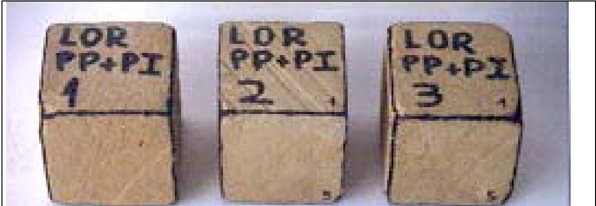
Foto 47. Probetas tratadas con PPPI por 6 caras, antes de ser envejecidas de la Calcilutita del Lorito.
