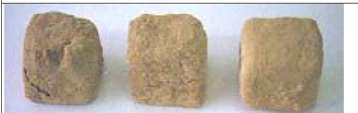
Foto 42. Probetas envejecidas de la Calcilutita del Lorito.
