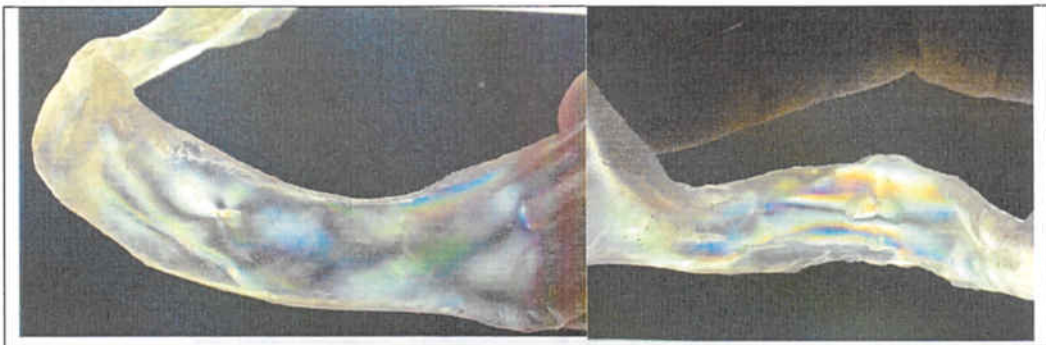
Fig. 4. Tensiones observadas mediante fotoelasticidad
