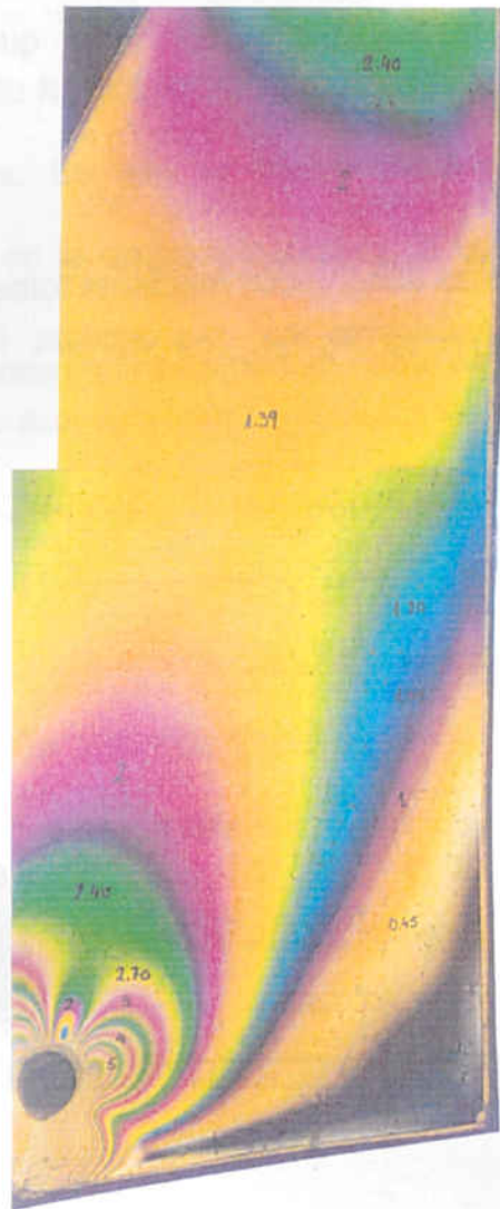
Fig. 1. Órdenes de franja N de isocromáticas en un polariscopio circular en campo oscuro y fuente de luz blanca.
