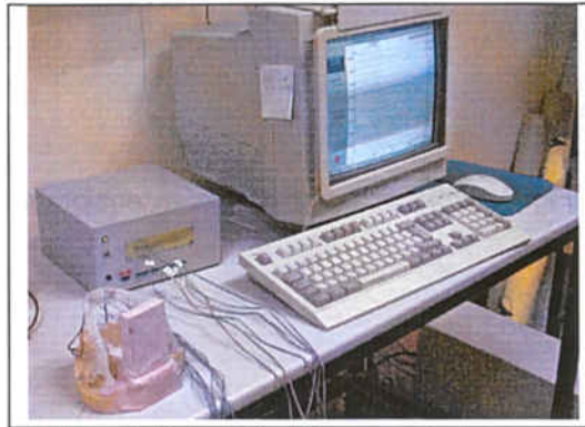
Fig. 9. Potenciómetro conectado a un ordenador
