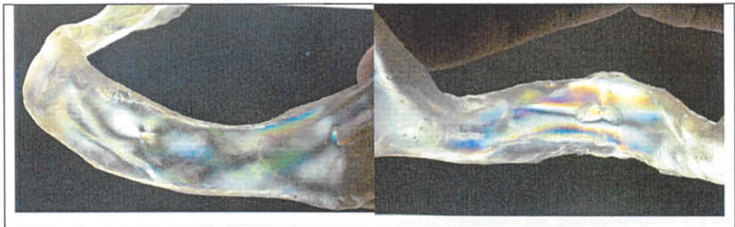
Fig. 13. Zonas de tensión en la mandíbula de resina fotoelástica
