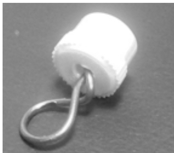
Figura 2. Tapón luer con dispositivo de anclaje de acero para pruebas de tracción.
