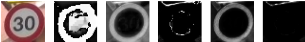
Figura 2.8: D'esquerra a dreta: imatge en RGB, canal H, canal S, activació h_{blau} , activació h_s , producte h_{blau} \times h_s
