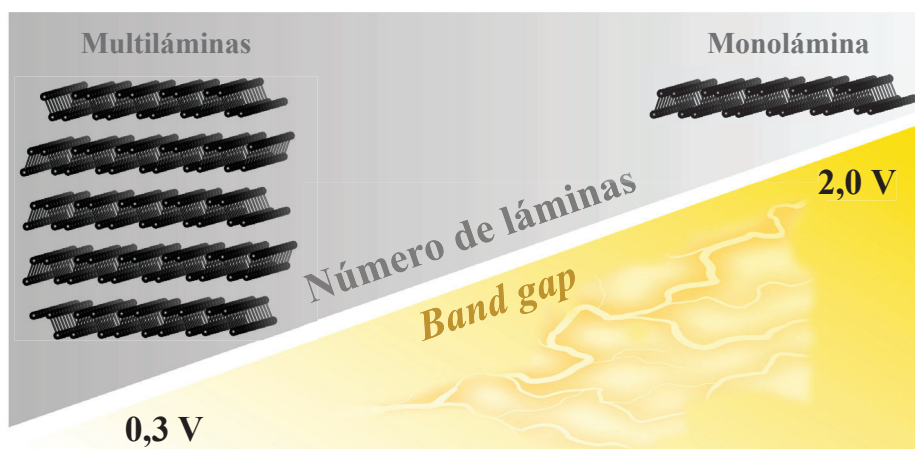
Figura 32. Esquema de relación entre el número de láminas y el band gap .
