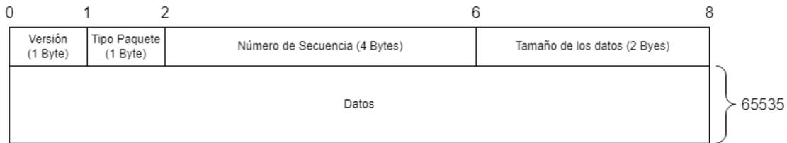
Figura 6: Estructura de un paquete de DeProtocol.
