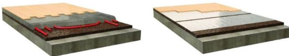
Imagen 16. Suelo radiante tradicional y eléctrico [XIV]
