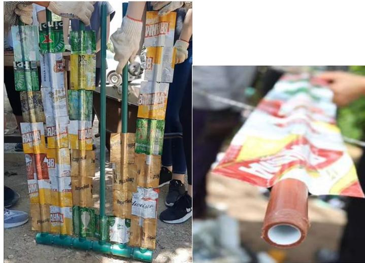
*Imagen. 8: Captador solar de colector de materiales reciclados. Fuente: Sumando Energías*
