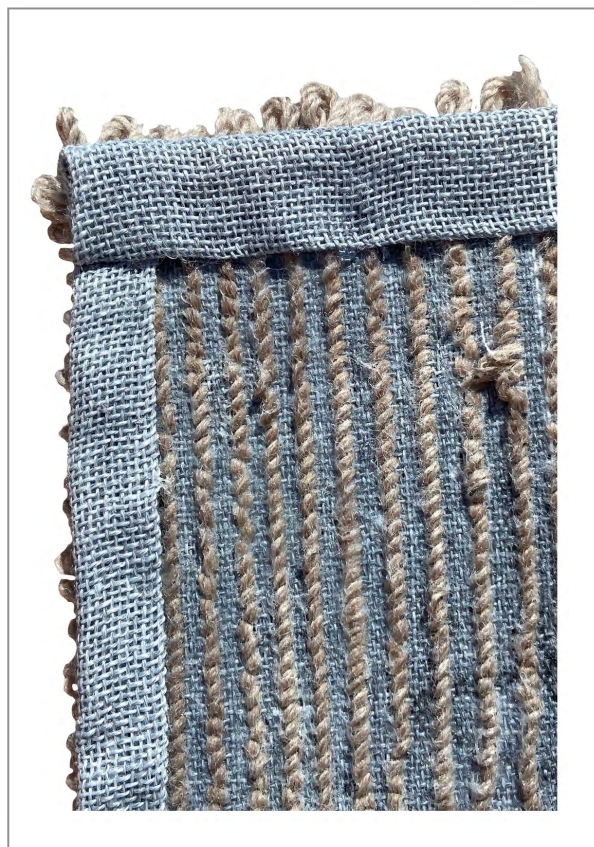
Figura 7. Detalle de la parte trasera de una pieza tejida con la técnica del tufting . En esta pueden verse las hebras de lana incrustadas en la base textil como resultado del trabajo que ejerce la máquina. Se trata de una base hecha de prueba y con otros materiales sin los acabados. (2023) Foto propia.
