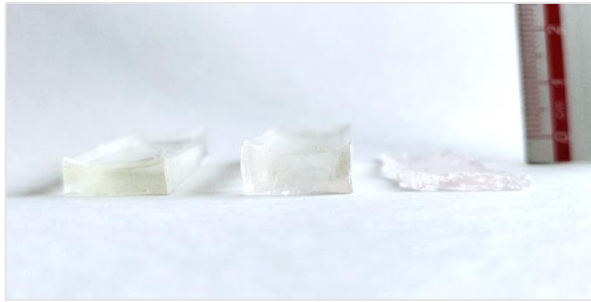
Imatge 32 Diferència de gruix entre HXTAL NYL-1, l'Araldite® 2020 i el Paraloid® B-72, d'esquerra a dreta.
