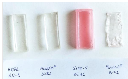
Imatge 29 Resultats obtinguts amb els motlles després de tres setmanes d'assecatge.
