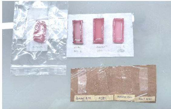
Imatge 28 Resultat de la creació de les provetes abans de l'enduriment.
