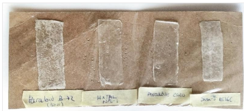
Imatge 34 Resultat de l'aplicació sobre paper japonès de Paraloid® B-72, HXTAL NYL-1, Araldite® 2020 i SIOX-5 RE16C, d'esquerra a dreta.
