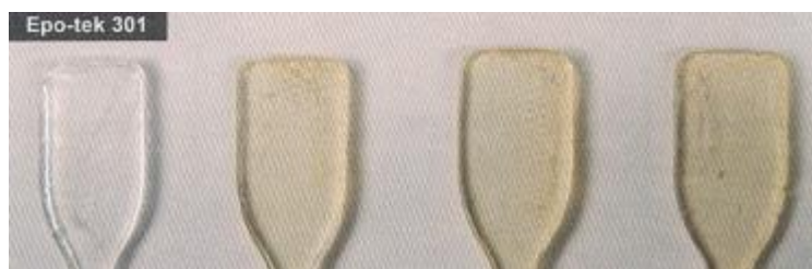
Imatge 12 Resultat de l'exposició a la llum del Epo-Tek ® 301 durant 0, 100, 200 i 300 h d'esquerra a dreta, per Coutinho, Ramos, Lima i Fernandes, 2008.
