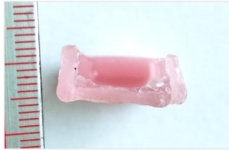
Imatge 33 Gruix resultant del SIOX-5 encara dins del motlle després de tres setmanes d'assecatge.
