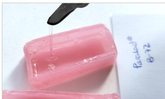
Imatge 31 Viscositat del Paraloid® B-72 després de 7 dies d'assecatge.
