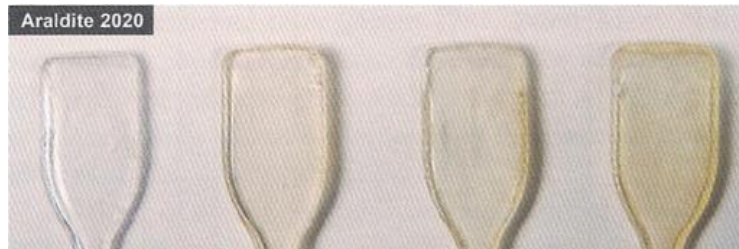
Imatge 11 Resultat de l'exposició a la llum de l'Araldite® 2020 durant 0, 100, 200 i 300 h, d'esquerra a dreta, per Coutinho, Ramos, Lima i Fernanedes, 2008 .
