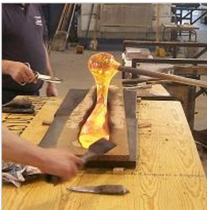
Imatge 18 Representació de la tècnica del vidre colat, per Real Fàbrica de Cristales de la Granja, s.d.
