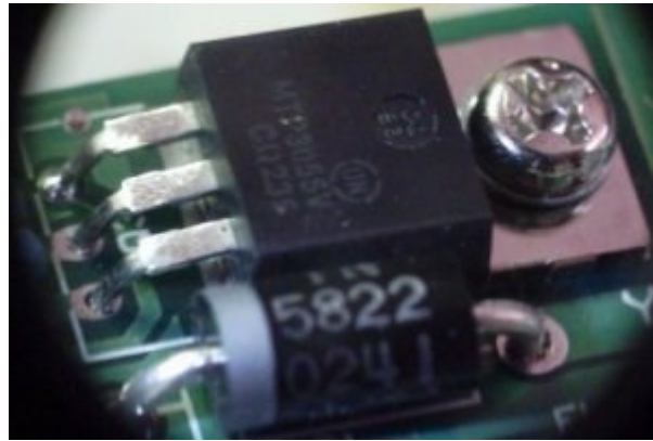
Figura 5. Muntatge d'un integrat en format TO220, tombat en placa i sense dissipador.
