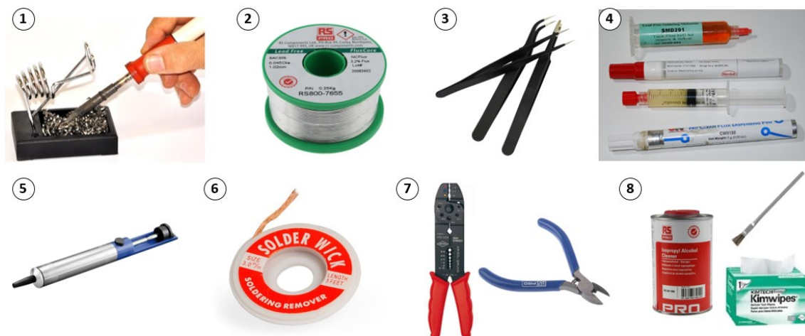
Figura 12: Material típic emprat en la tècnica de soldadura.
