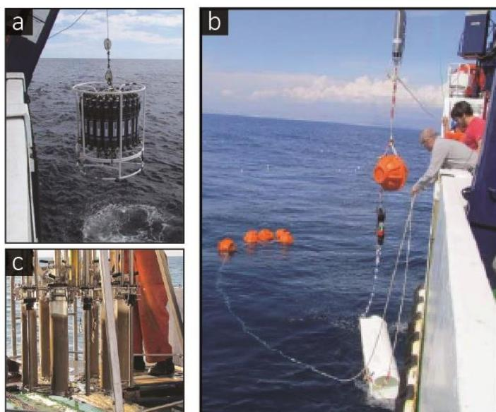
**Figura 2.1.** Fotografies il·lustratives dels treball efectuats durant la campanya NUREIEV-1. (a) Maniobra de recuperació de la roseta amb el CTD. (b) Maniobra de fondeig d'una línia instrumentada. S'observa una trampa de partícules (cilindre blanc), un correntòmetre (cilindre negre, gris i vermell) i un alliberador acústic (cilindre gris), a més d'un seguit de boies i cordam. (c) Testificador múltiple amb els tubs plens de sediment, a la coberta del vaixell.
