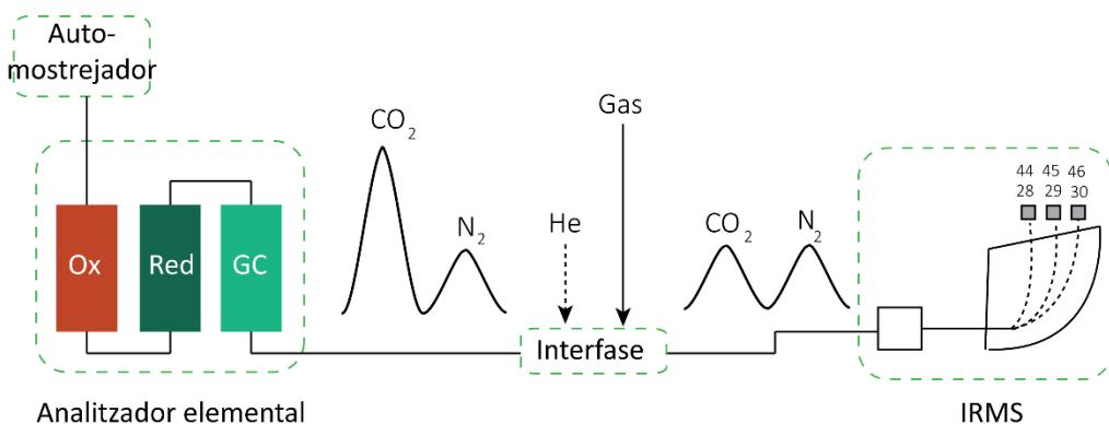
**Figura 2.4.** Esquema d'un analitzador elemental acoblat a un espectròmetre de masses de relacions isotòpiques (IRMS). Ox: oxidació. Red: Reducció. GC: cromatògraf de gasos. Les xifres de dos díigits damunt el dibuix de l'IRMS fan referència al ràtio m/z (massa/càrrega) dels ions de C i N.
