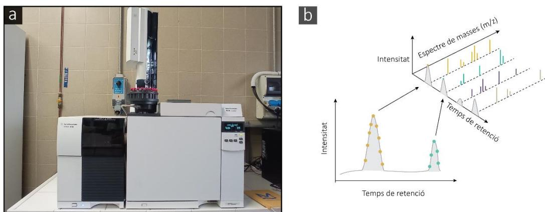
**Figura 2.5.** (a) Cromatògraf de gasos acoblat a un espectròmetre de masses de l'*Istituto di Scienze Polari del Consiglio Nazional delle Ricerche* de Bolonya, emprat per analitzar els biomarcadors en mostres de partícules en suspensió i sediments en el marc d'aquesta Tesi. (b) Esquema d'un chromatograma i l'espectre de masses associat.
