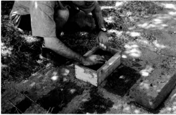
FIGURA 13: Procés d'elaboració de les toves (Laboratori d'Arqueologia Experimental del Vendrell).
