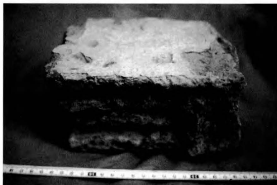
FIGURA 3: Tova procedent del jaciment de Barranc de Gàfols, on s'aprecia, en una de les cares, una sèrie de soles dins els quals ha penetrat el morter de fang.
