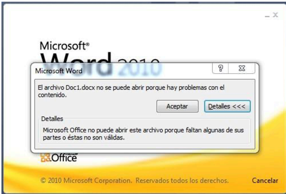
Figura 2. Error mostrat per Microsoft Word 2010 en obrir un document desat amb l'estàndard OOXML estricte.
