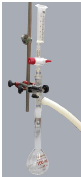
Figura 126. Muntatge per dur a terme l'escissió del pèptid de la resina a escala de mg de resina.
