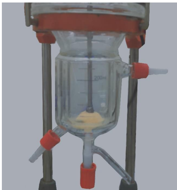
Figura 20. Reactor 2 amb l'agitador A i la resina després de la filtració.
