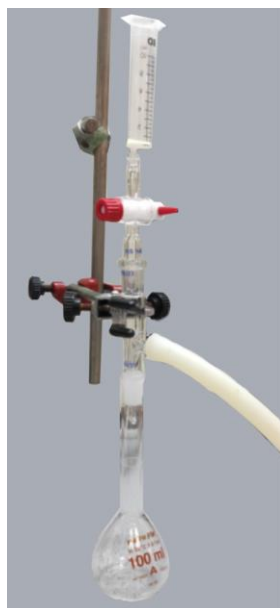
Figura 23. Muntatge per dur a terme l'escissió del pèptid d'una alíquota de resina (mg).
