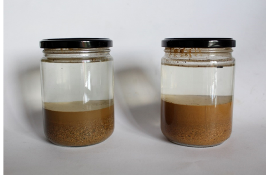
Imatge 7 · Resultat de les proves granulomètriques de dos tipus de terra.
