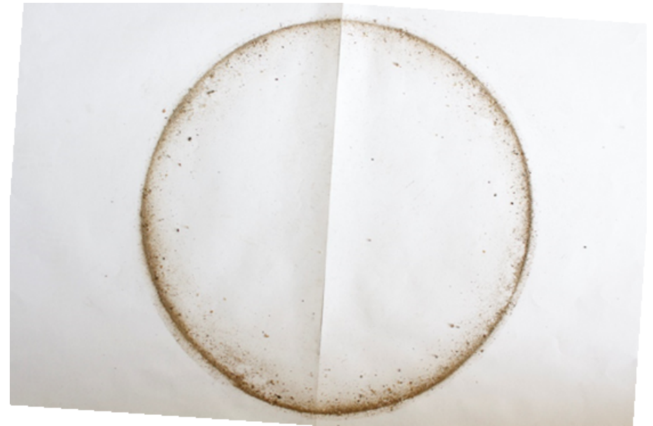
Imatge 6 · Disposició de la brutícia sobre la superfície durant la neteja d'un tamís.
