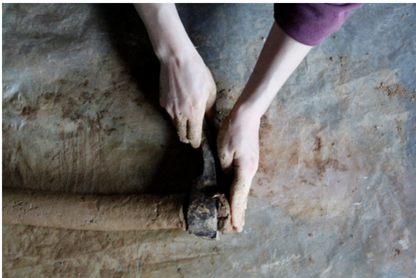
Imatge 19 · Procés d'acoblar el mànec a l'aixada.
