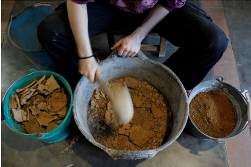
Imatge 15 · Procés d'esmicolar l'argila amb maça de fusta.
