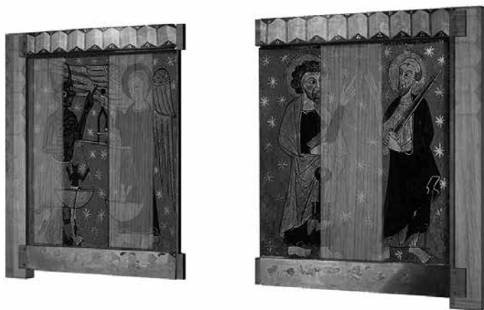
[fig. 1] Recreació virtual en 3D i policromada del suport del conjunt de Ribes. Transparència del 25 % dels muntants verticals del marc per visualitzar la posició dels encaixos a caixa i espiga (detall de les llengüetes dels muntants horitzontals del marc que encaixen als muntants verticals). Transparència del 25 % de la primera i la tercera post del plafó central de la taula MEV 9695 i de la segona post de la taula MEV 9694 per visualitzar el nombre de posts que té cada plafó central
