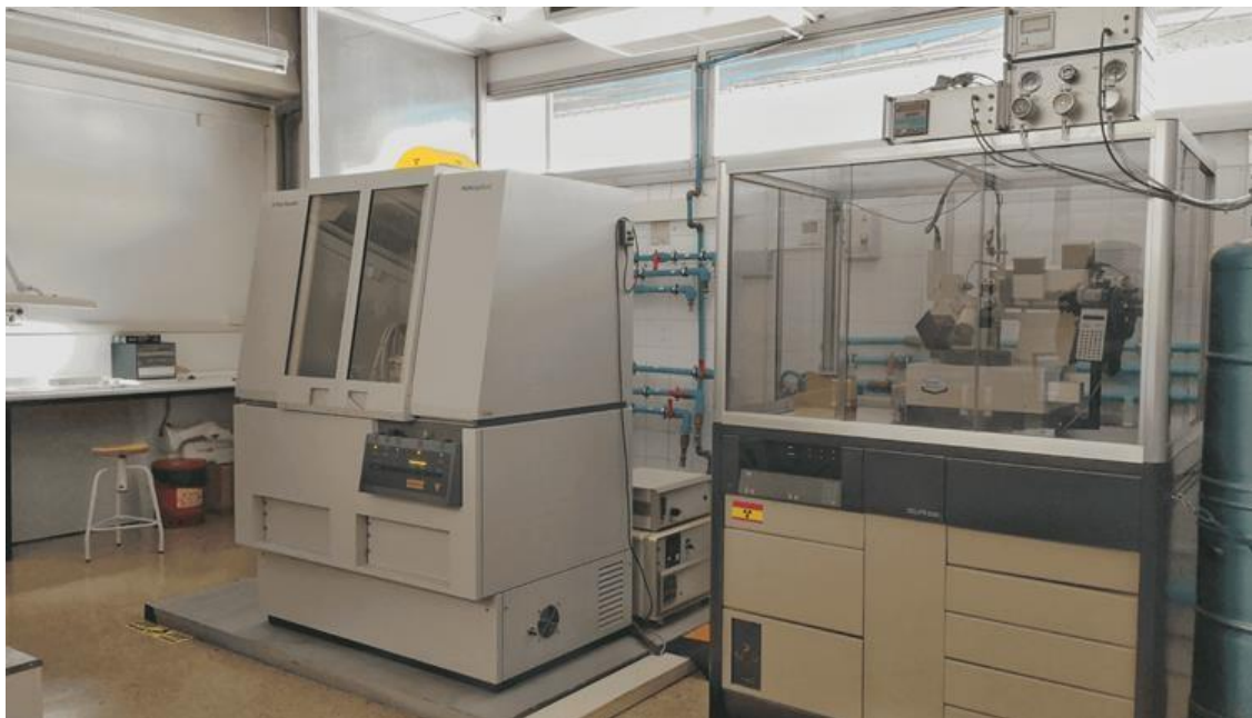
Figura 10: Fotografia pròpia que mostra l'equipament utilitzat al servei de DRX de la Universitat Autònoma de Barcelona.
