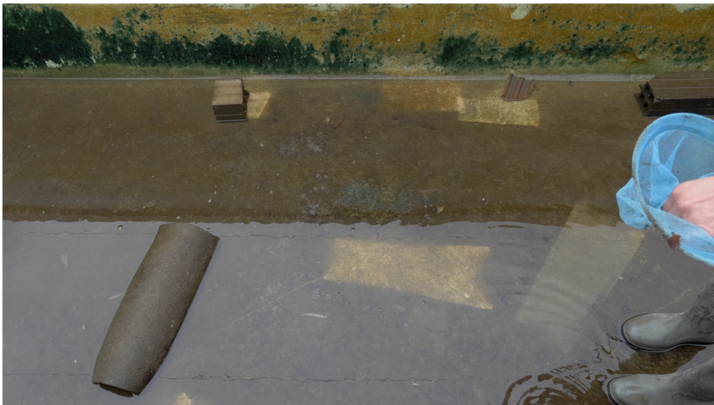
Figura 60. Formes resultants del desplaçament de teules i totxanes. Monitoratge audiovisual. [Fotograma]. Autor de la imatge: Job Ramos, 2020.
