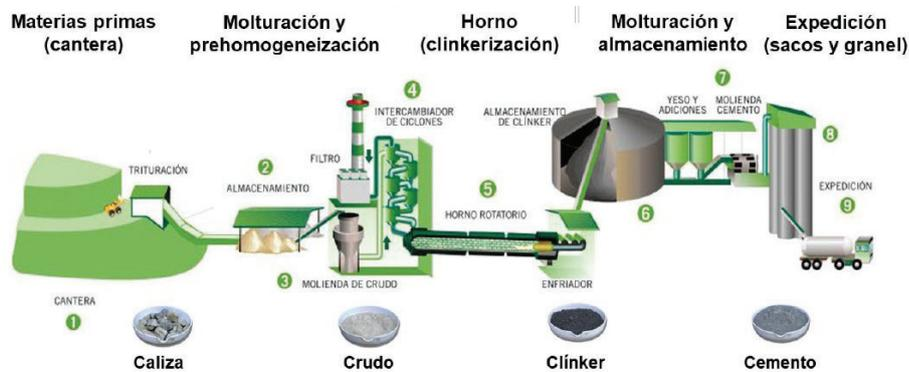
Figura 2.1 Proceso industrial de la fabricación de clínker. [Curso de química del cemento]
