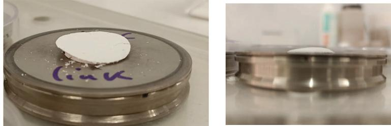
Figura 4.30 Porta-muestra DRX expansión del Link-Evr post análisis
