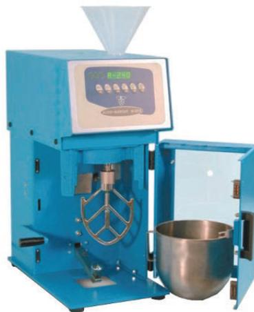
Figura 5.5 Mezcladora de mortero planetaria utilizada durante la experimental de la presente tesis doctoral
