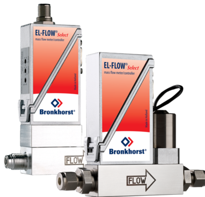
Figura 5: Aspecto físico de dos Mass Flow Controller de la marca Bronkhorst.
