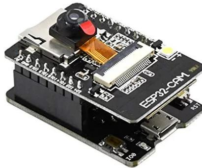
Figura 2: Módulo ESP32-CAM con la cámara OV2640 integrada
