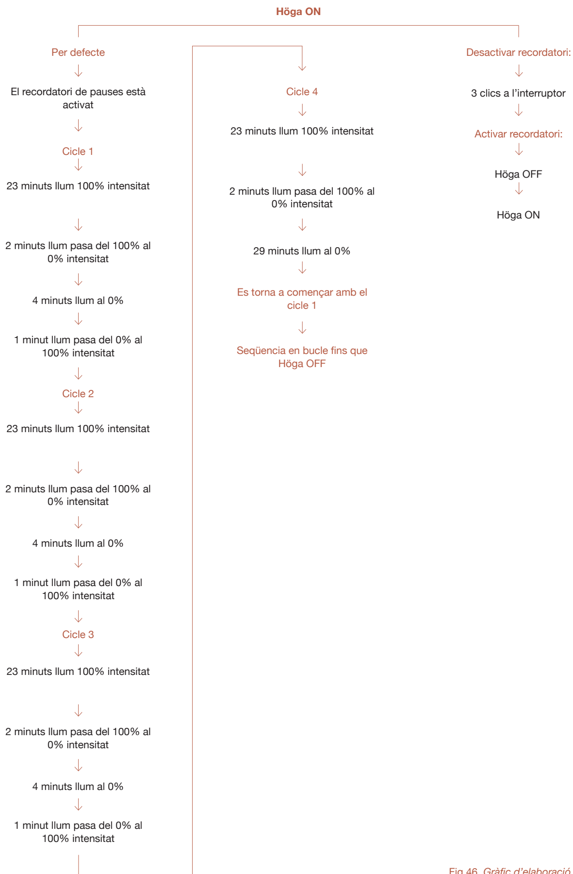
Fig 46. Gràfic d'elaboració pròpia que mostra la seqüència de configuració del xip Arduino.
