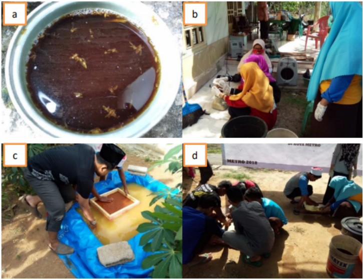
Figura 87: Procés de fabricació del paper de closca d'arròs: (a) cocció de la closca; (b) destrucció de la closca; (c) impressió; (d) assecat.extreta de Zarnuji, A., Amrulloh, H., & Azizah, I. N. (2019). Utilization of rice husk waste for paper raw materials as an Arabic calligraphy media. ENGAGEMENT: Jurnal Pengabdian Kepada Masyarakat
