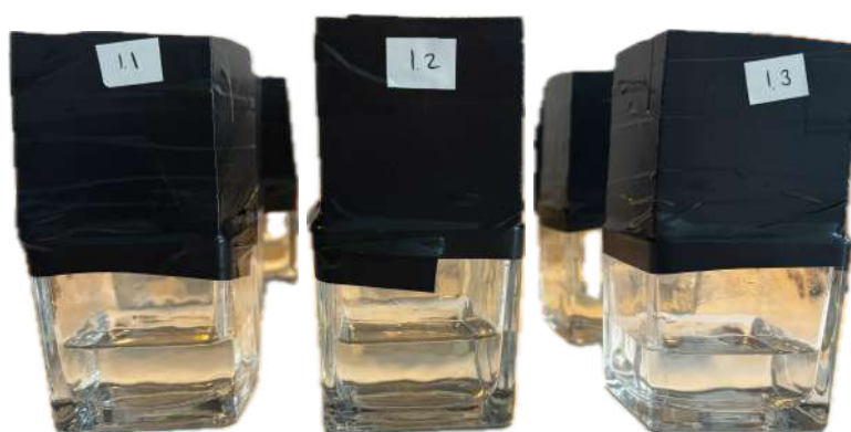
Fig. 8 Imatge de les provetes. Cada mostra està fixada a la cubeta i segellada amb cinta aïllant.
