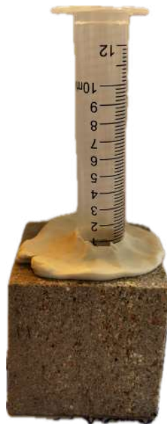
Fig. 7 Imatge del procediment de l'assaig. S'observa la xeringa a manera de pipeta fixada amb plastilina a la superfície de la proveta.
