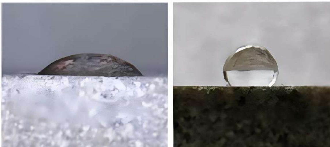
Fig. 9 Comparativa de dues imatges obtingudes de la mostra 2.1 abans i després del tractament hidrofugant.
