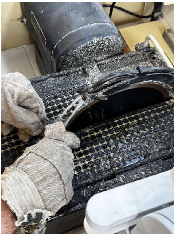
Fig. 8 Tall dels blocs definitius que s'empraran com a mostres.
