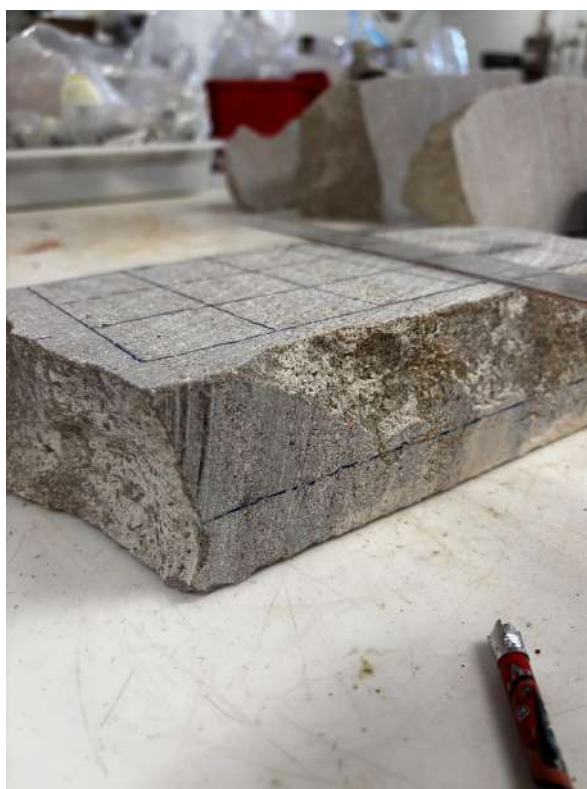
Fig. 7 Bloc de pedra mesurat i marcat per procedir amb el tall.
