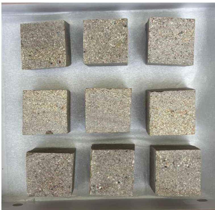
Fig. 5 Imatge dels tres grups de mostres. En la primera fila, les mostres del grup Hidrofugant 1. En la segona fila, les mostres del grup Hidrofugant 2. En la tercera fila, les mostres de control.
