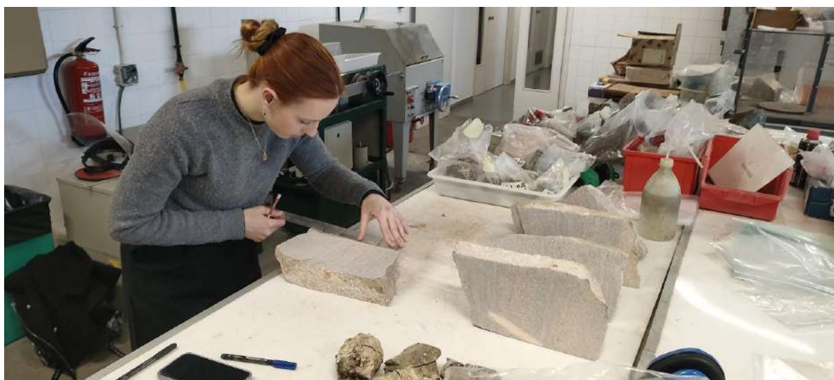
Fig. 5 Procés de medició i marcatge dels blocs de pedra per procedir amb la segona fase del tall.
