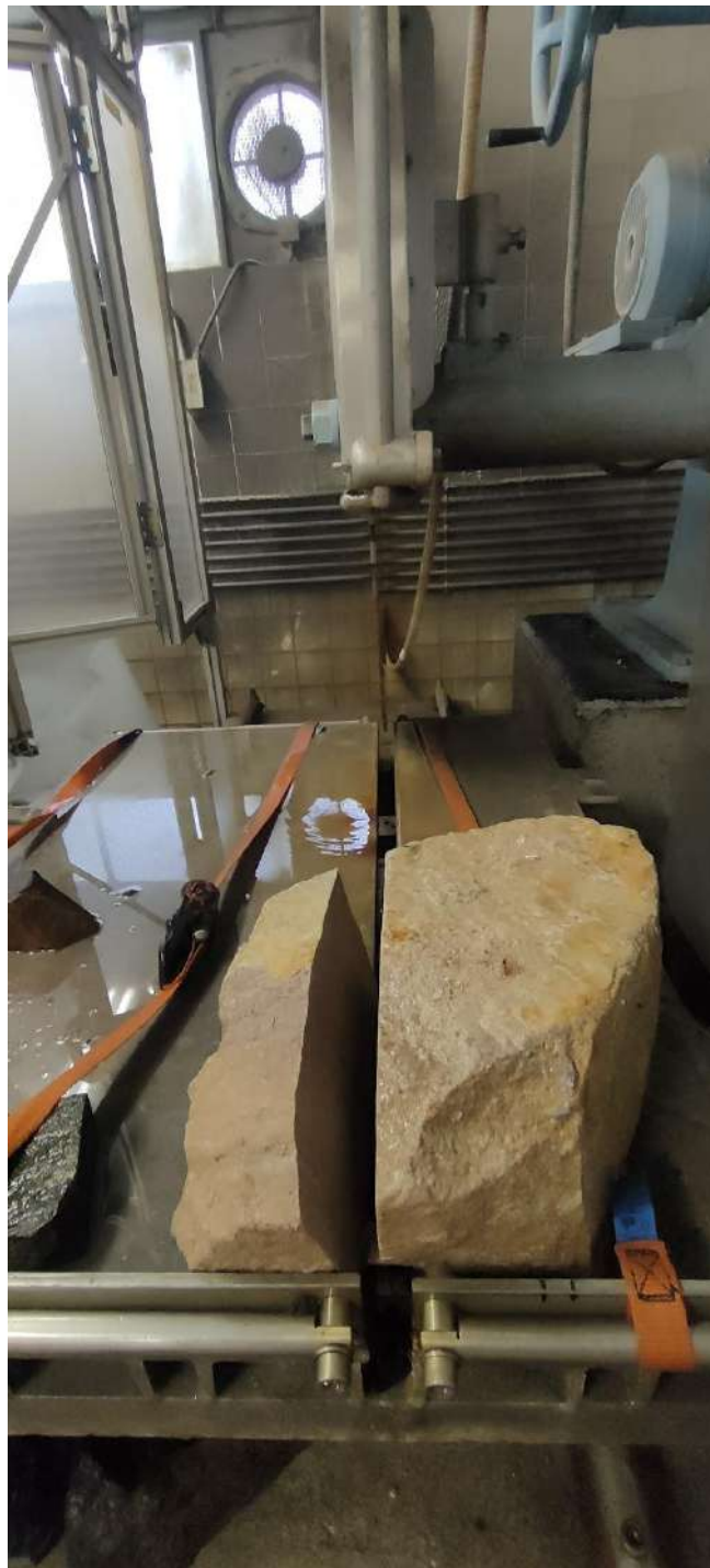
Fig. 3 Procés de tall del bloc de pedra inicial. Primer tall.
