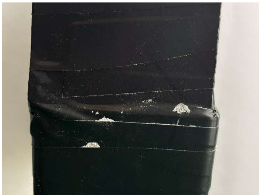
Fig. 12 Fuites de vapor d'aigua (solució salina) que deixa rastres de sals cristalitzades sobre el material que feia la funció d'aïllant.
