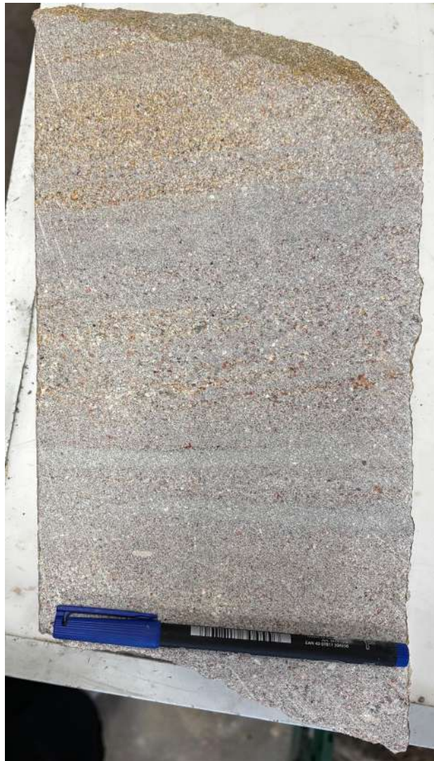
Fig. 4 Bloc de pedra de Montjuïc després dels primers talls. S'observa l'estructura estratigràfica laminada.
