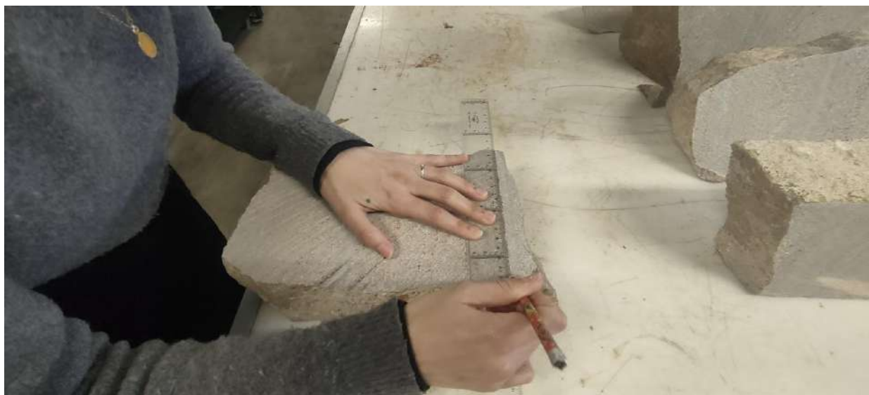
Fig. 6 Detall del procés de medició i marcatge dels blocs de pedra per procedir amb la segona fase del tall.
