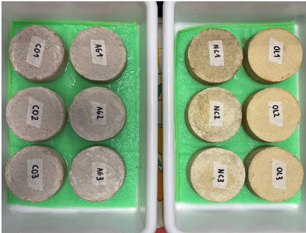
Figura 2. Provetes de morter col·locades sobre la baieta humida.
