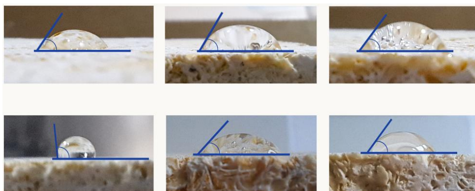
Figures 35, 36, 37, 38, 39 i 40 . Fotografies representatives de la prova de la gota, en què s'observen els angles de contacte mesurats. Les imatges superiors corresponen a les mostres abans de l'aplicació dels consolidants, mentre que les imatges inferiors mostren les mateixes mostres després del tractament .
