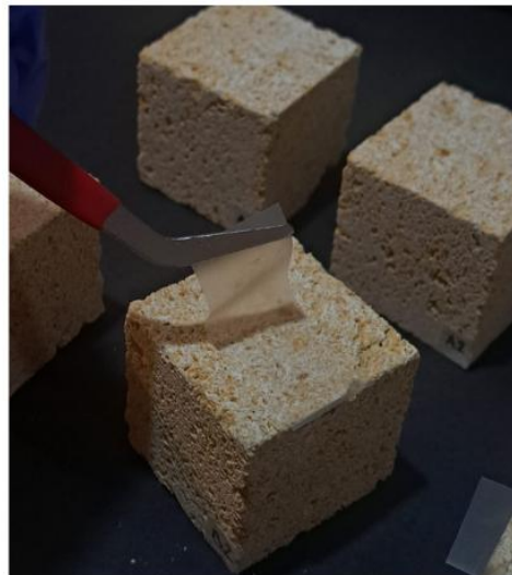
Figures 26 i 27 . A l'esquerra es mostren els materials específics emprats en el Scotch tape test, i a la dreta, el procés d'aplicació de la cinta sobre la mostra (prova).
