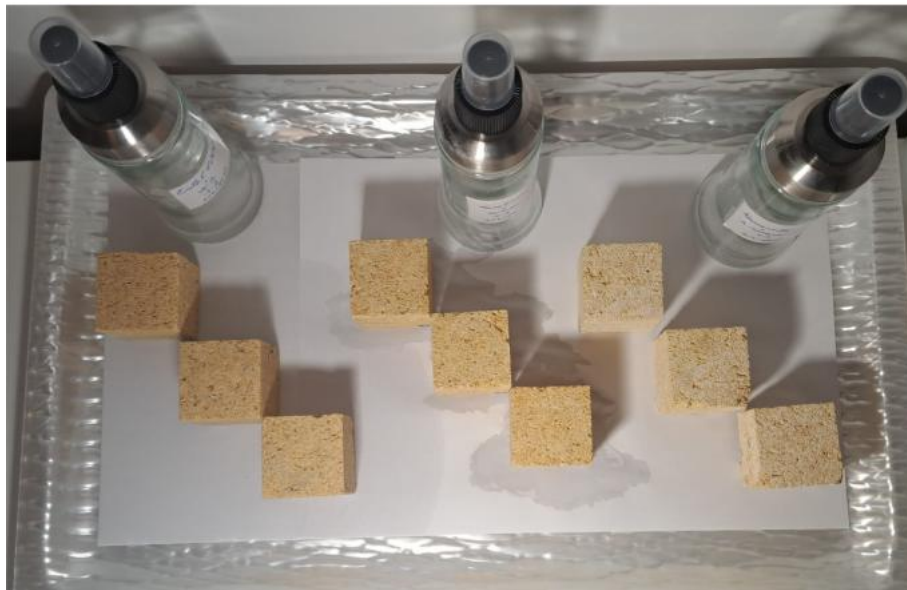
Figura 34. Els cubs amb els seus respectius esprais amb la dissolució de consolidant i dissolvent. En aquesta posició, els cubs es van deixar reposar durant un mes.
