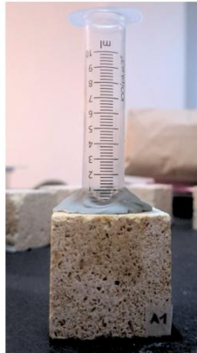
Figures 24 i 25. A l'esquerra es veuen els materials específics emprats en la prova d'absorció, i a la dreta, el procés d'aplicació sobre la mostra.
