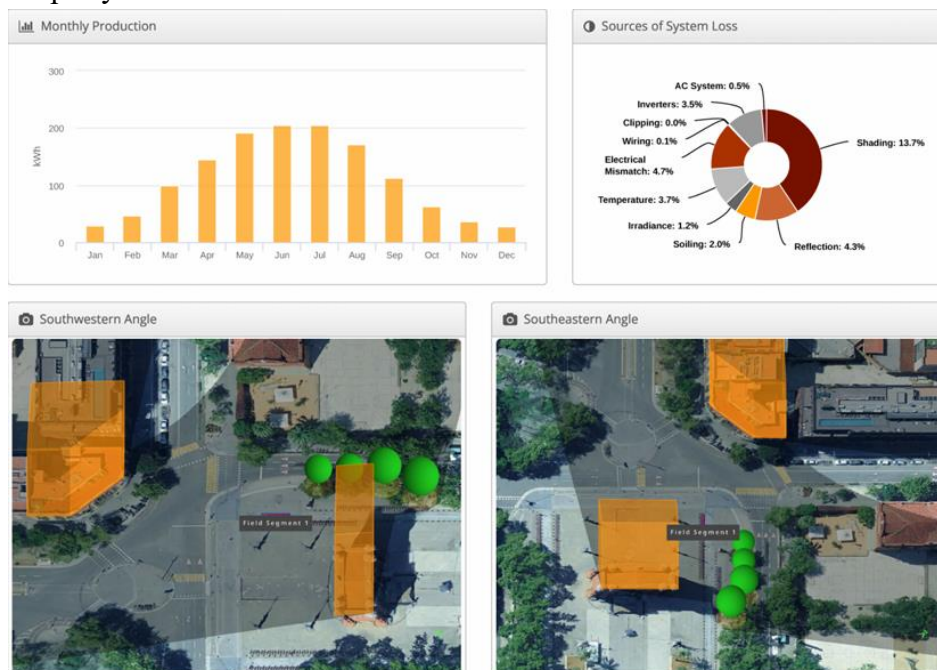
Figura 3. Simulación FV en la estación Pg. de Lluís Companys (Arc de Triomf): producción mensual, fuentes de pérdidas y vistas de sombreado. Fuente: HelioScope, simulación realizada por el autor (2025).
