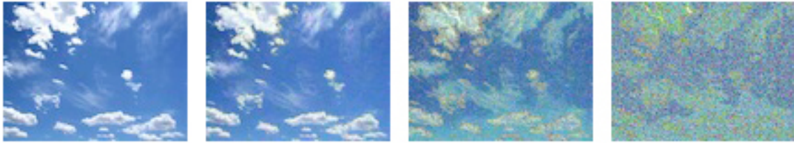
Imagen 15. Fotografía digital en JPG sometida a repetidas compresiones en cuatro fases del proceso
