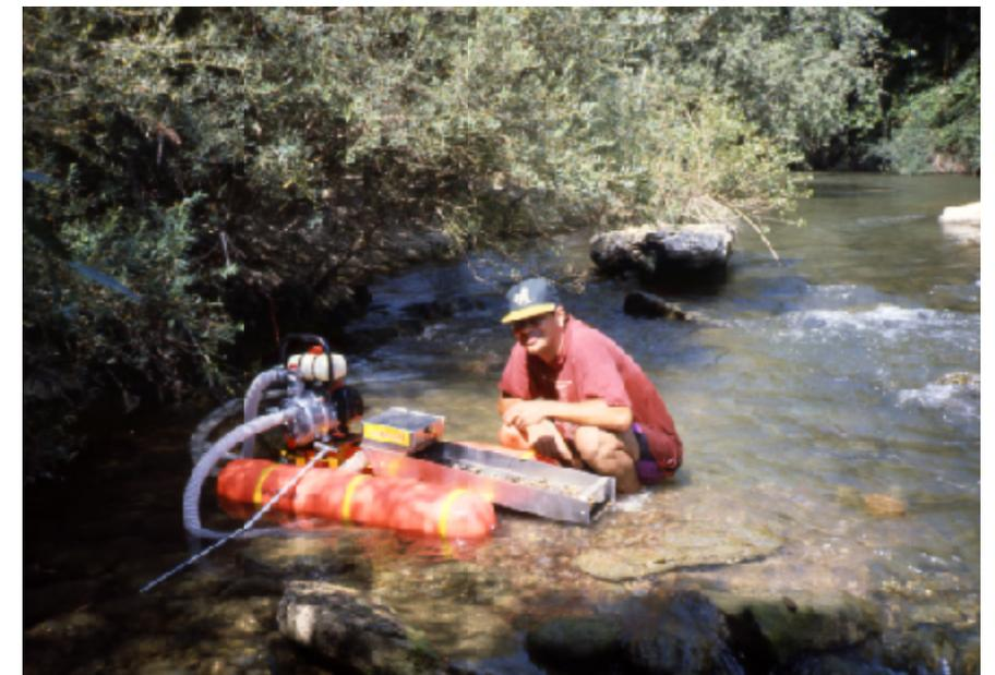
Minidraga con sluice box
