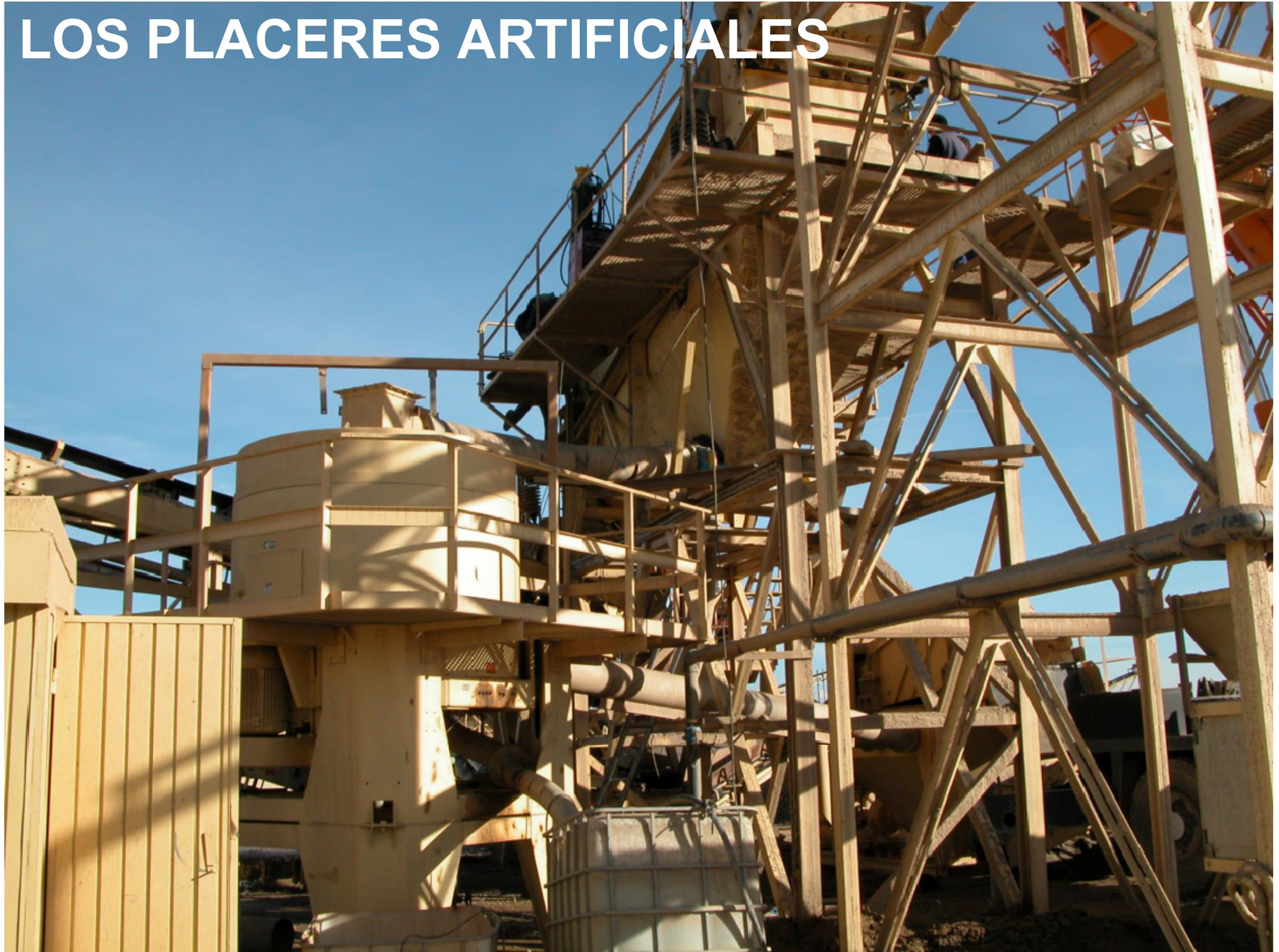
*El Corb (Balaguer, Lleida). Planta de lavado y cribado y concentrador gravimétrico.*
