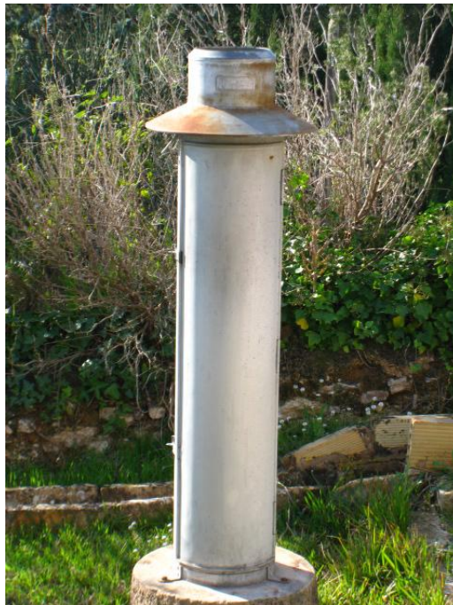
Figura 10: Pluviògraf Lambrecht instal·lat a l’Observatori de l’Ebre.
