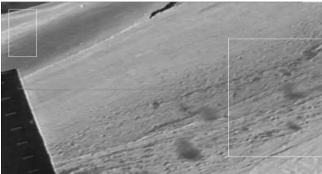
Image 4-16. Image de l'avalanche du 15 Janvier 1992. A gauche, en bas, le support de capteurs profilé en aile d'avion, en haut, fenêtre déterminant la portion de surface utilisée pour calculer la densité spectrale du bruit (utilisée ultérieurement dans l'étude temporelle). A droite : fenêtre déterminant la portion de surface étudiée.
