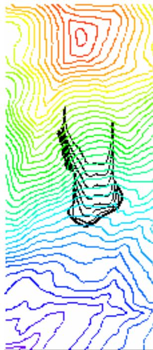
Figure 6-5. Evolution du front de l'avalanche simulée au cours du temps (Naaim, Com. Pers.).
