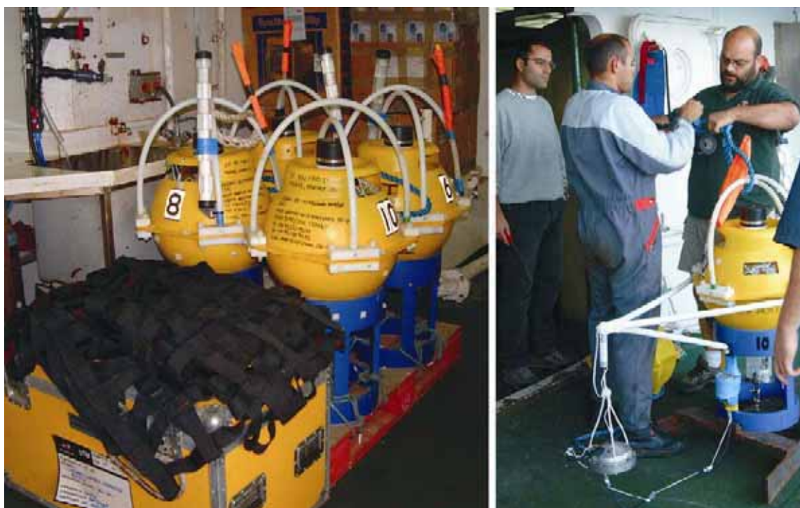
Figura 7. 4.- Sismòmetres profunds (OBS) gestionats per la UTM del CSIC. Equip tècnic de la UTM preparant-se per a fondejar un dels seus instruments.
