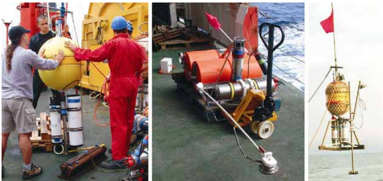
Figura 7. 5.- Diferents tipus d'instruments aportats i gestionats per GEOMAR. La fotografia de l'esquerra mostra un hidròfon de profunditat (OBH) preparat per a ser fondejat, i les dues fotografies restants mostren els dos tipus de sismòmetres de fondària (OBS) emprats en aquest experiment.
