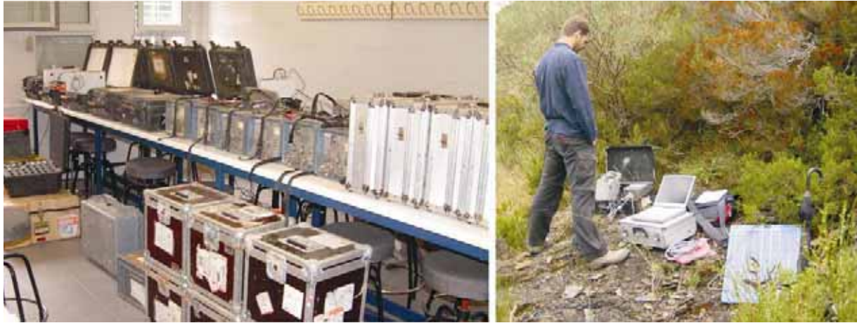
Figura 7. 7.- Laboratori de la Universitat d'Oviedo amb part de les estacions sísmiques Reftek, MarsLite i Hathor emprades durant la campanya MARCONI 2003 en el moment de la seva revisió prèvia a l'inici de l'experiment. Visió general d'un dels emplaçaments en el moment de la instal·lació d'un instrument Hathor. En primer pla apareix el panell solar emprat per alimentar les bateries de l'estació.
