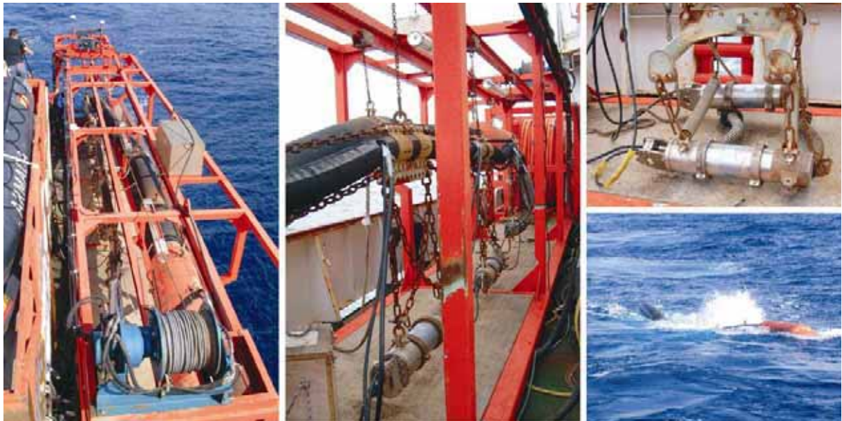
Figura 7. 3.- Conjunt de canons d'aire comprimit emprats com a font sísmica i dispositiu mecànic destinat a facilitar al seu arriat i hissat a bord. Es mostra un detall de l'enfilall de canons penjant del flotador i una vista de la bombolla d'aire generada, a 9 m de fondària sota el flotador, pels canons en ple funcionament.
