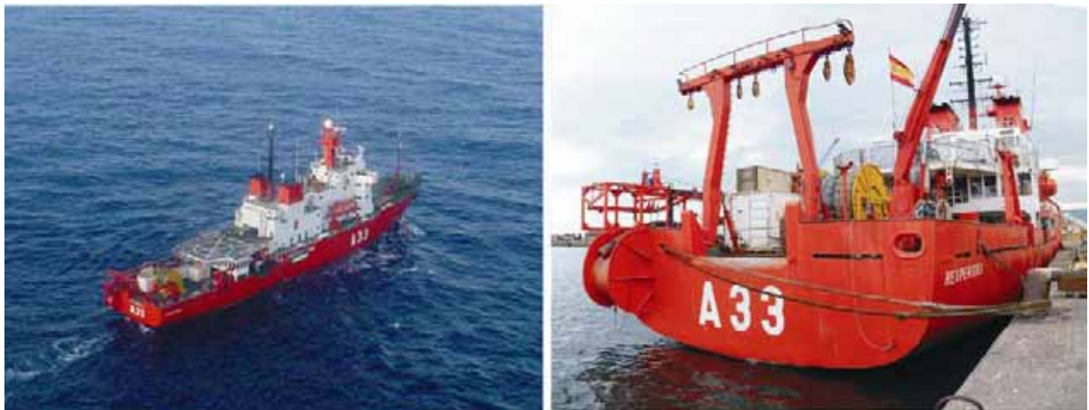
Figura 7. 1. Vista aèria del BIO Hespérides navegant, durant el procés desplegament dels OBS de la campanya MARCONI 2003, cap al següent punt de la xarxa. Visió parcial de la popa del vaixell, on s'aprecia la bobina del streamer emprat per a la sísmica de reflexió vertical, el contenidor dels compressors per alimentar els canons d'aire comprimit i el dispositiu mecànic emprat per arriar els canons pel mirall de popa del vaixell.
