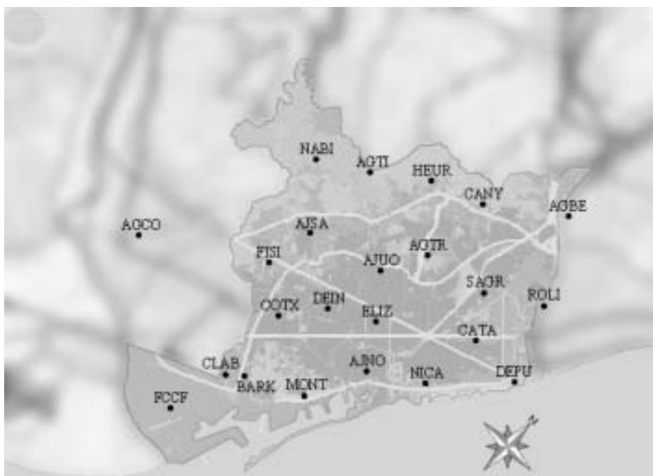
Fig. 3.14 Red de pluviómetros de intensidad de tipo balancín de CLABSA en Barcelona
