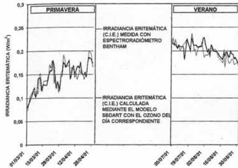
Figura 2 - Comparación entre la irradiancia eritemática medida y la modelizada. (Comparison between measured irradiance and modeled).
