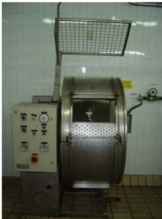
Fig. 4.8. Bombos d'acer inoxidable de 120 cm x 60 cm
