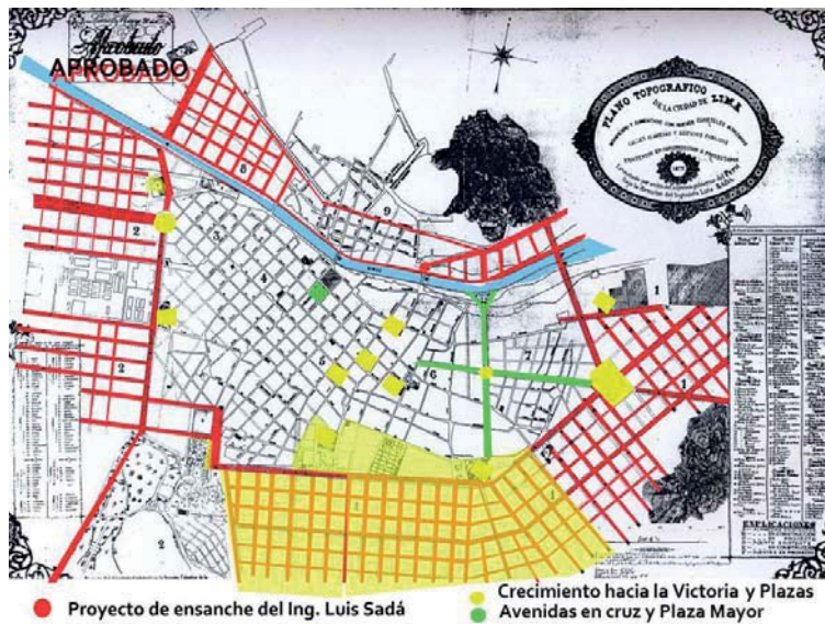
Figura 30. En el plano se esquematiza el proyecto de urbanizar fuera del perímetro de la ciudad fundacional. Se señala también en verde la Plaza Mayor y en la zona este las avenidas dispuestas en cruz. En amarillo el Arrabal de la Victoria y las Plazas proyectadas. Plano proyectado por el Ingeniero Sada para hacer el ensanche de Lima. Considerado el primer plan regulador de la ciudad de Lima en 1872. 70
