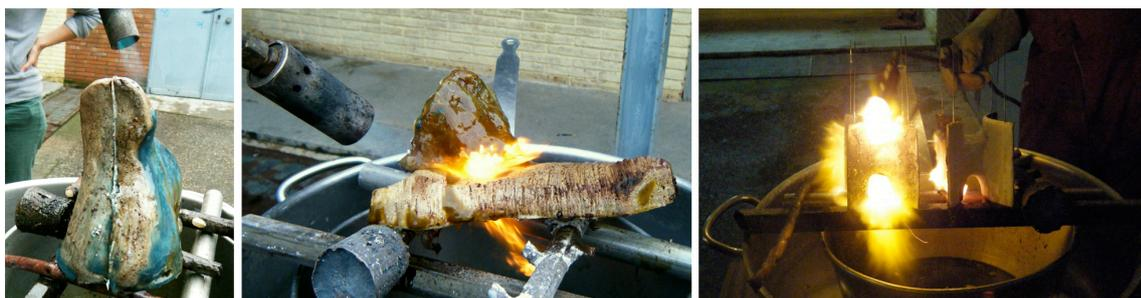
Figura I.1. Descerado mediante soplete de gas
