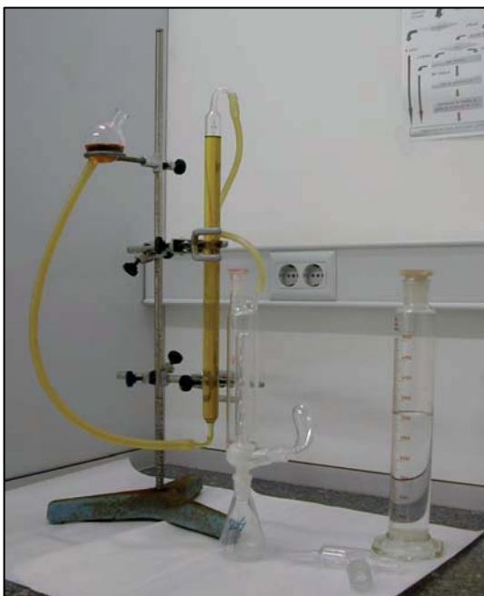
Figure 4.4. Bernard calcimeter at the Institut de Ciències del Mar (CSIC) in Barcelona.
